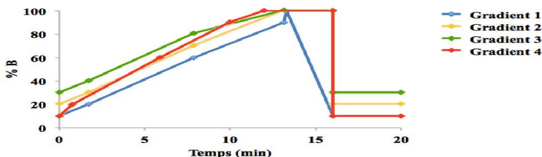
Figure 26. Gradients d'élution testés pour la séparation des coumarines et furocoumarines en UPLC.
