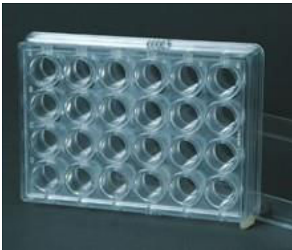
Figure 52 : Représentation d'une boîte Linbro permettant l'affinement des cristaux obtenus avec les kits de cristallisation (Hampton research).
