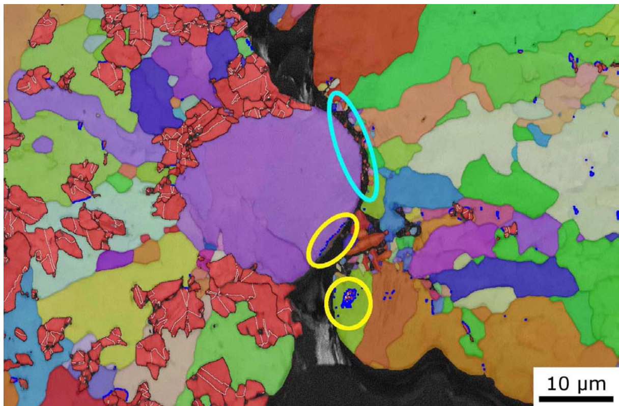
Figure IV-11 : Analyse EBSD d'un cou interrompu à 725°C. La phase \alpha est représentée selon un code de couleur IPF d'orientation. La phase \gamma est représentée en rouge avec les joints de macles de 60° selon l'axe \langle 111 \rangle en blanc. Les lignes bleues correspondent à des grains \gamma en relations de Blackburn avec des grains \alpha .
