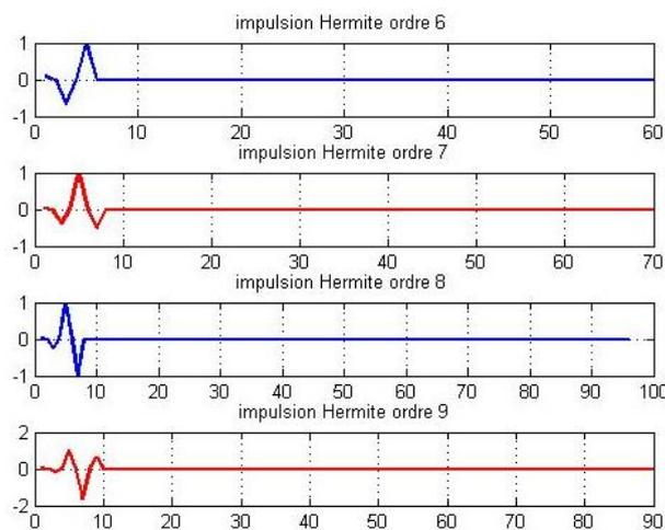
Figure 53 : Formes d'impulsions d'Hermite d'ordres 6, 7, 8 et 9
