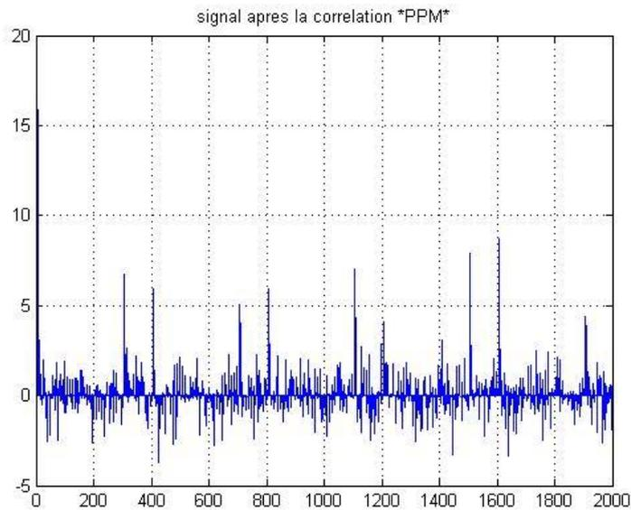
**Figure 66 : Corrélation du signal reçu après modulation PPM**
