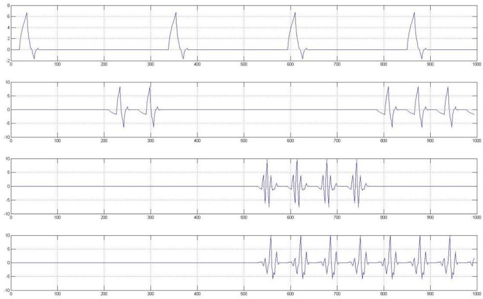
Figure 93 : Exemple de trains d'impulsions au niveau 4 pour les entrées 1,2,3 et 4, ondelette Daubechies 2
