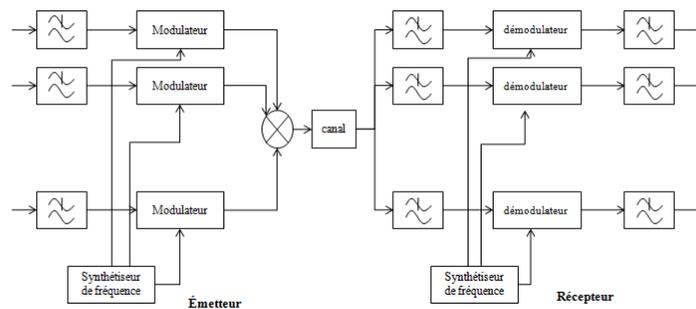
Figure 11 : Architecture d'émetteur-récepteur selon le principe du FDMA
