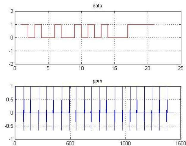
Figure 58 : Signal après la modulation PPM
