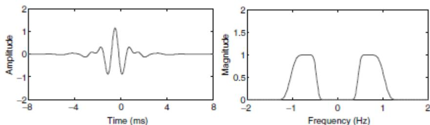
Figure 82 : Représentation de l'ondelette de Meyer en temps et en fréquence [GAO11]
