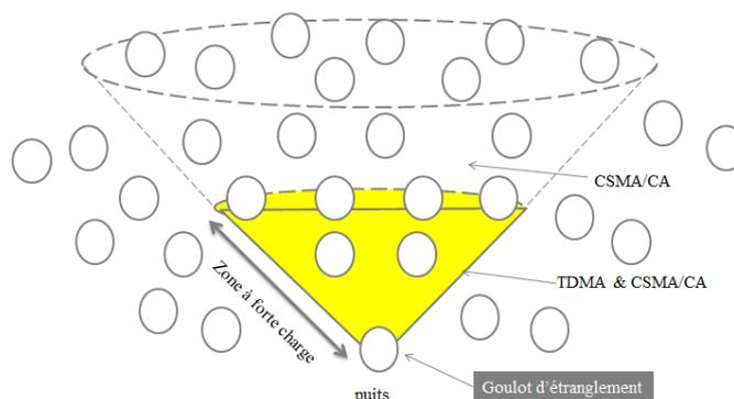
Figure 26 : Principe du protocole *Funneling* MAC
