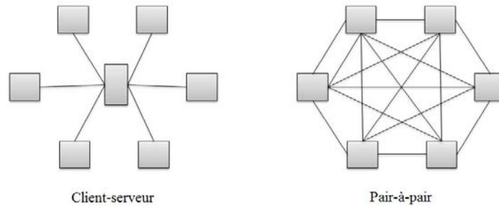
Figure 1 : Topologie des réseaux de capteurs
