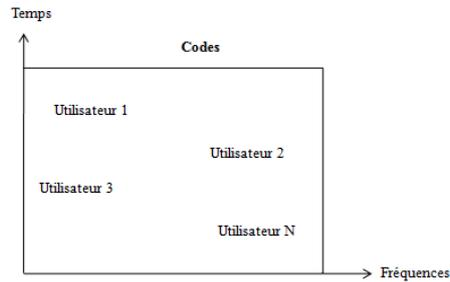
Figure 14 : Principe du CDMA
