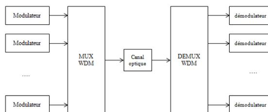
Figure 13 : Principe de fonctionnement du WDM
