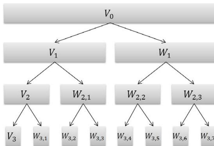
Figure 74 : Analyse en paquets d'ondelette
