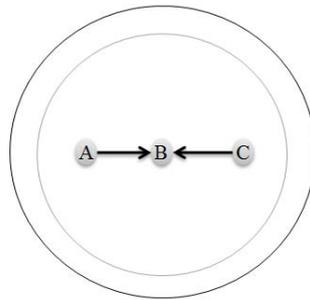
Figure 19 : Problème de collision dans le protocole CSMA/CA
