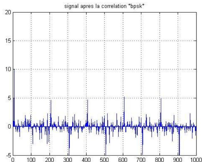
Figure 64 : Corrélation du signal reçu après modulation BPSK
