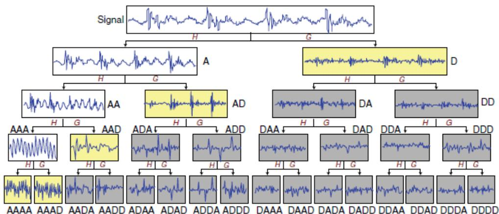
Figure 75 : Procédure de décomposition à l'échelle 4 par la transformée en paquets d'ondelettes discrète.
