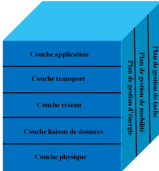
Figure 3 : Pile protocolaire typique des réseaux de capteurs sans fil
