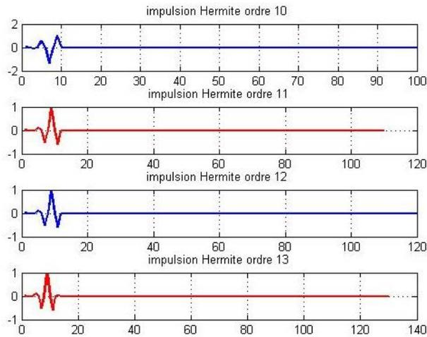
Figure 54 : Formes d'impulsions d'Hermite d'ordres 10, 11, 12 et 13
