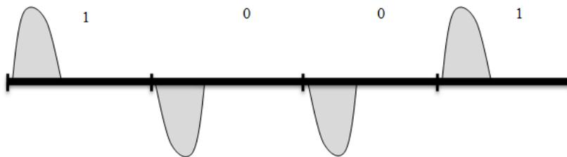
Figure 34 : Modulation BPSK
