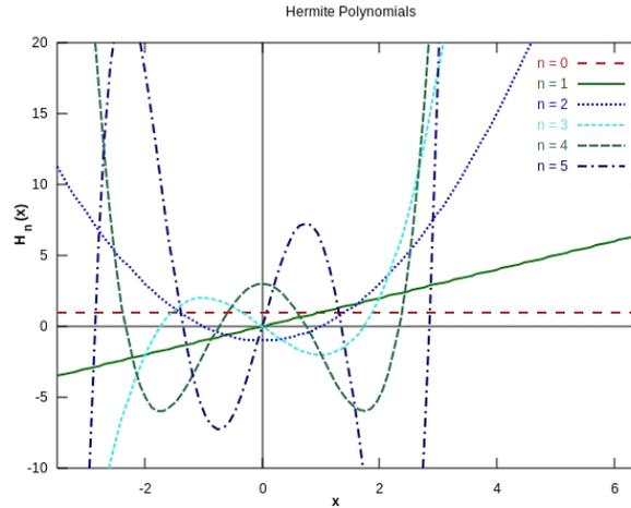
Figure 51 : Les formes d'impulsions d'Hermite suivant plusieurs ordres
