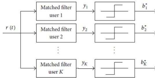
Figure 16 : Récepteur dans le cas du WDMA [YIN14]
