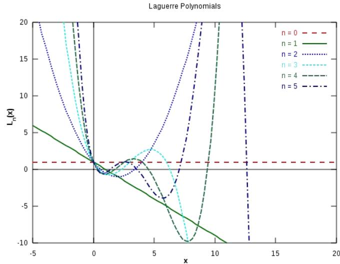
Figure 48 : Forme des impulsions via le polynôme Laguerre
