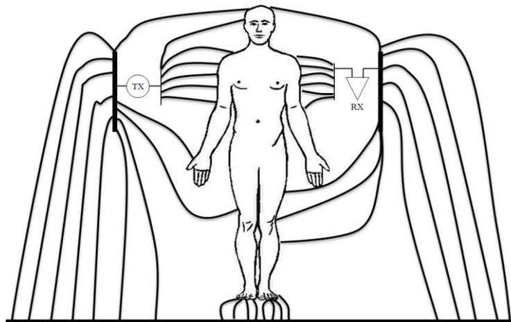
Figure 8 : Couplage capacitif
