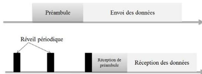
Figure 22 : Principe du LPL (*Low Power Listening*)
