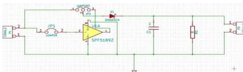
Figure 44 : Schéma de détecteur d'énergie analogique
