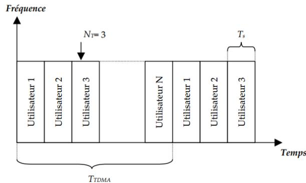
Figure 10 : Principe de fonctionnement du TDMA
