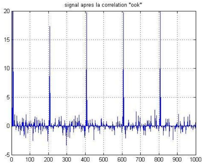
**Figure 65 : Corrélation du signal reçu après modulation OOK**
