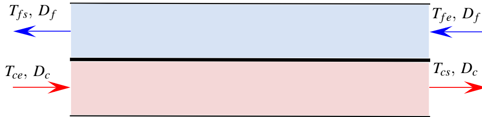
FIGURE 4.8 – Echangeur thermique à contre-courant
