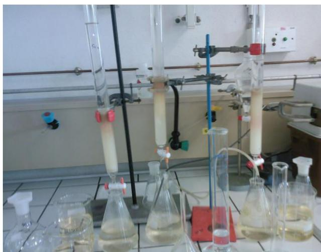
Figure 3:2 Photo de colonnes de silice permettant de séparer les classes lipidiques
