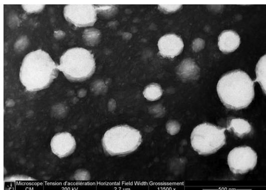
**Figure 4:23 Photographie au microscopie électronique à transmission représentant le CoQ<sub>10</sub> solubilisé dans les gouttelettes lipidiques d'une émulsion riche en AGPI-LC**
