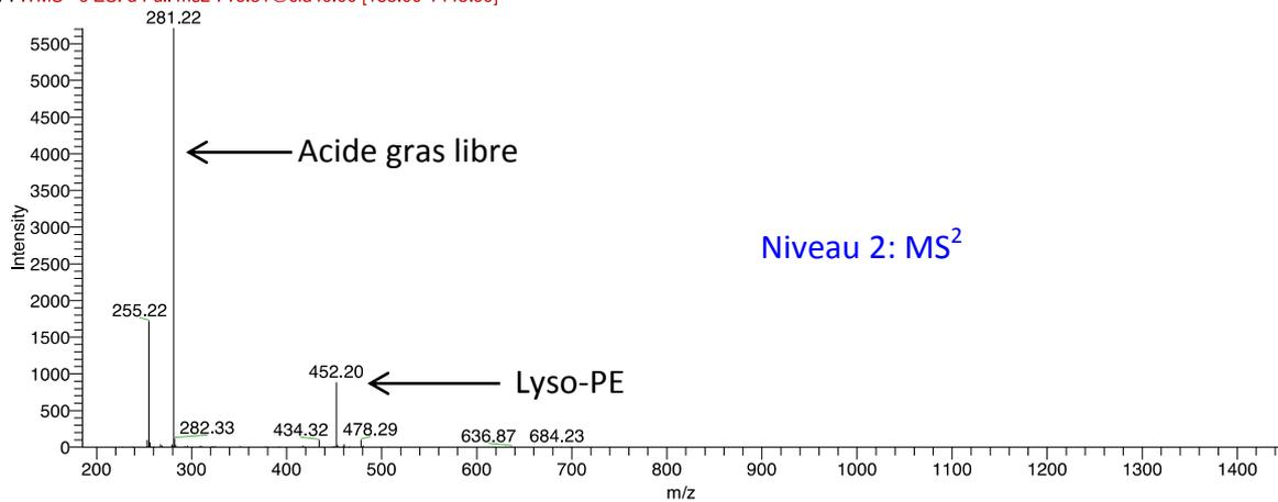
Figure 4:11 Etapes d'identification de la PE par LC-MS
