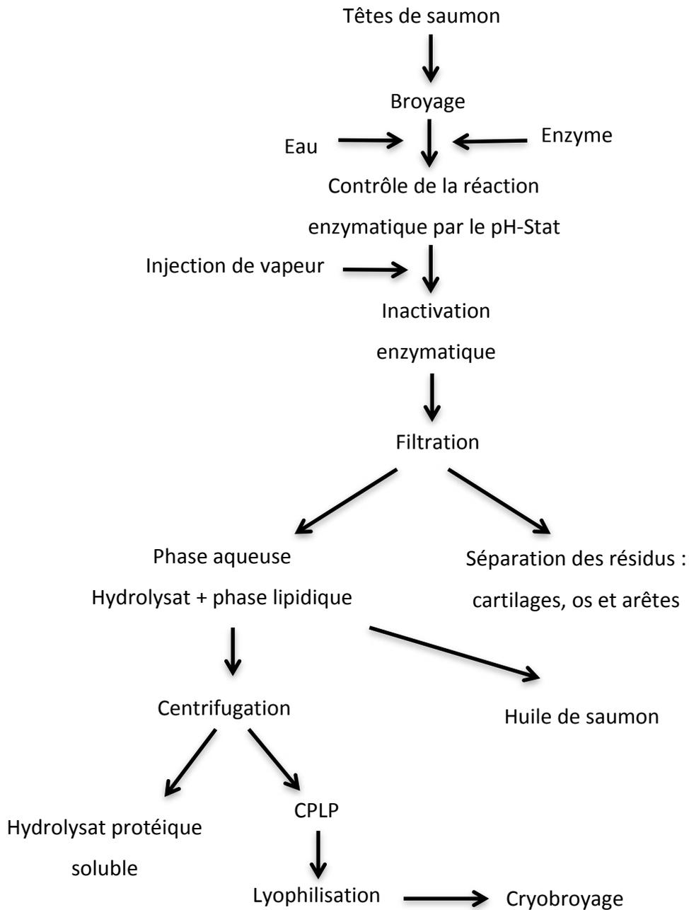
Figure 4:2 : Procédé d'extraction de l'huile de saumon et obtention d'hydrolysats protéiques.
