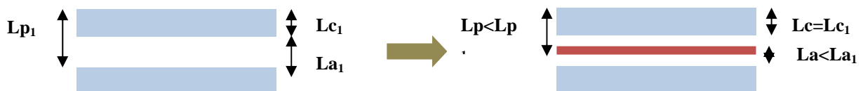
Figure III.66: schéma du mécanisme de cristallisation du PET
