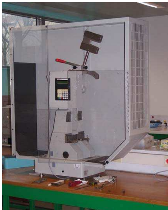
Figure II.18: image du pendule CHARPY utilisé. L'énergie de rupture est obtenue par lecture directe. .
