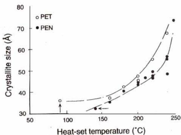
**Figure I.9:** évolution de l'épaisseur des cristallites du PET en fonction de la température de maintien. Le recuit est d'une durée de 30s (Verdu, 1994).
