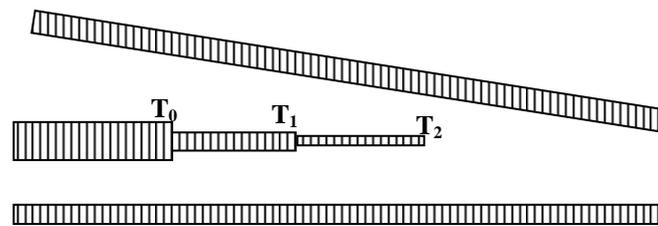
**Figure III.12** : développement des lamelles cristallines entre lamelles inclinées. T0 : fin de la cristallisation primaire, et continuation de la cristallisation secondaire avec l'apparition des épaisseurs décroissantes (Strobl, 1997).
