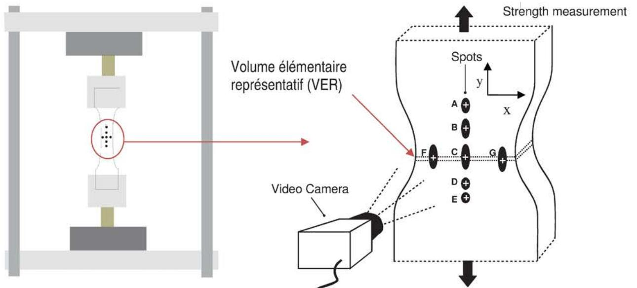
**Figure II.16:** description de l'essai de Vidéotraction®
