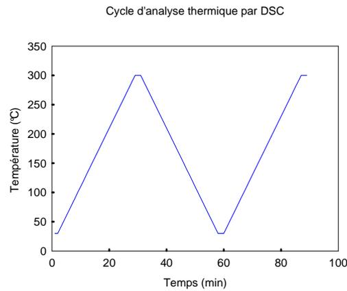
**Figure II.9:** le cycle thermique choisi pour les analyses par DSC
