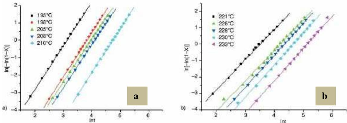
**Figure I.7** : les droites  $\ln(-\ln(1-X))$  en fonction de  $\ln t$  pour une cristallisation isotherme du PET et PET/agent nucléant :
