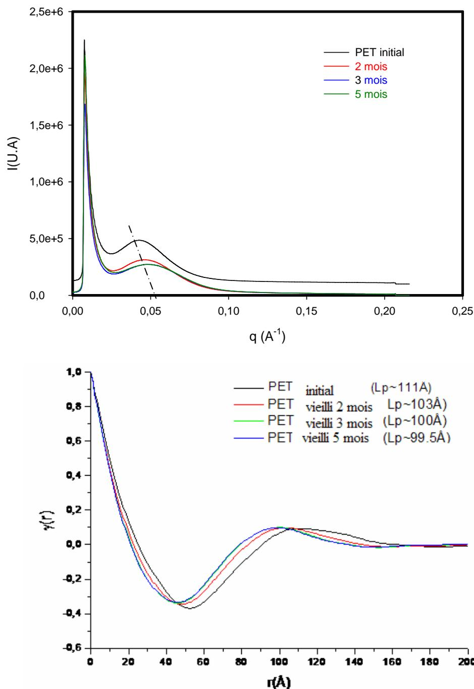
**Figure III.53** : diffractogrammes SAXS et les fonctions de corrélation  $\gamma(r)$  des échantillons vieillis à 125°C.
