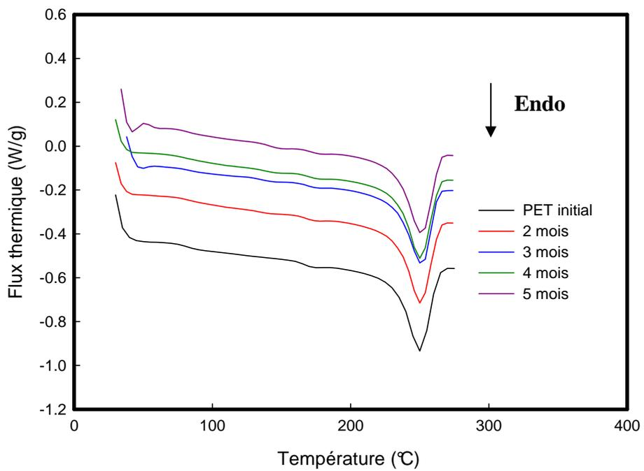
Figure III.32 : courbes DSC de PET vieillis à 115°C
