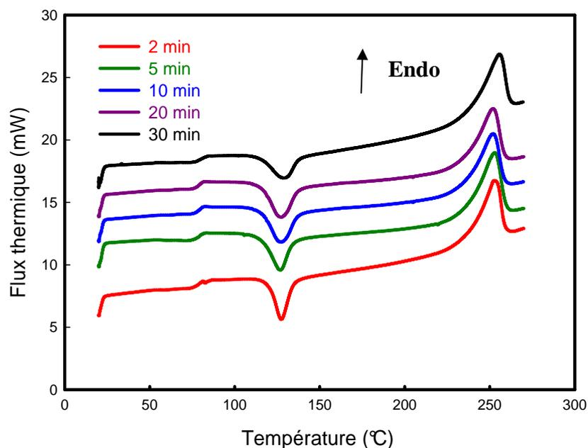
**Figure III.3 :** évolution des courbes de fusion des échantillons PET amorphe obtenu, maintenu à 120°C pendant des durée de maintien de 2, 3, 5, 10, 20, 30 minutes. La masse testée est  $m=10\text{mg}$ , la vitesse de chauffe est 10°C/min.
