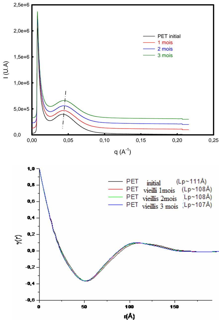
**Figure III.52:** diffractogrammes SAXS et les fonctions de corrélations  $\gamma(r)$  des échantillons vieillis à 115°C
