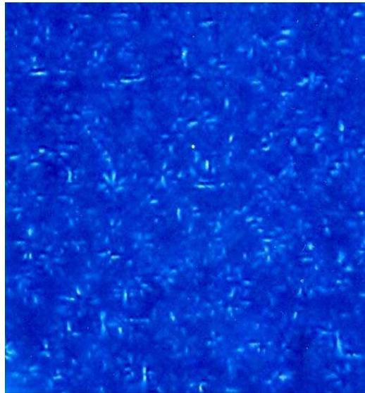
**Figure III. 14** : cristallisation isotherme d'un film PET d'épaisseur 100 $\mu$  à 235°C pendant t=1h30min.
