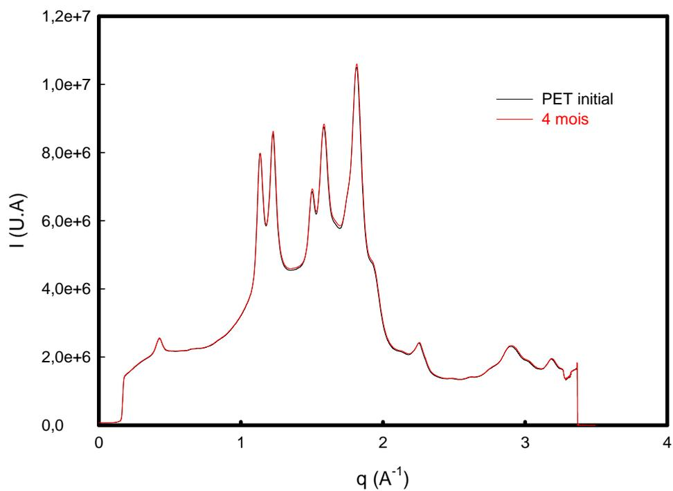
**Figure III.61:** diffractogrammes WAXS du PET vieilli à 60°C
