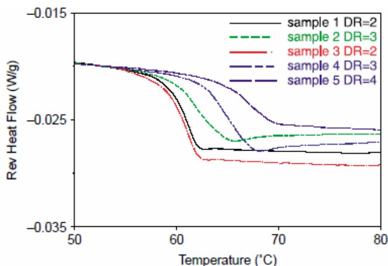
**Figure III.40** : température de transition vitreuse des fibres PLA (courbes réversibles).
