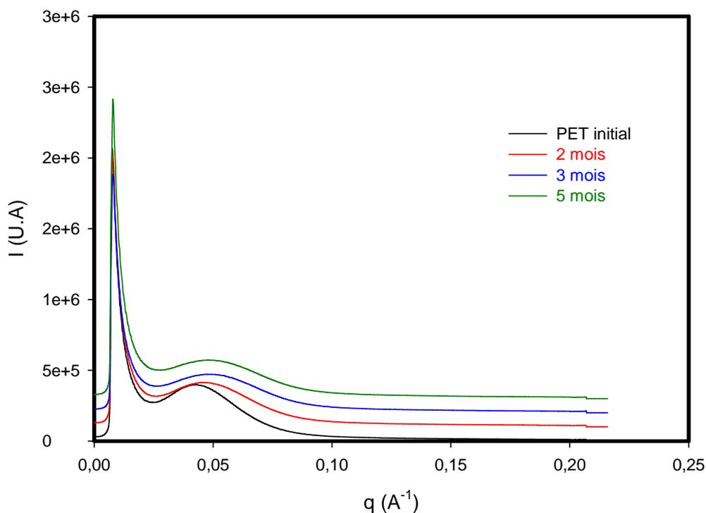
**Figure III.54:** les diffractogrammes SAXS des échantillons vieillis à 125°C, représentés séparément
