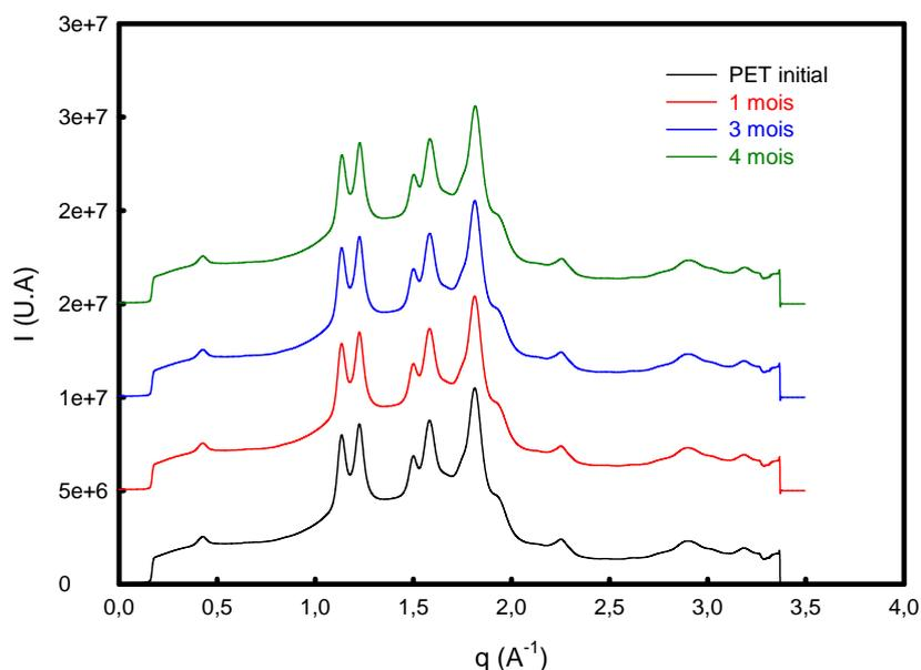
**Figure III. 60:** spectres WAXS des échantillons vieillis à 60°C
