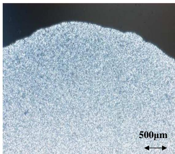
**Figure III.25:** image au microscope optique (polariseur croisé) d'un film PET.
