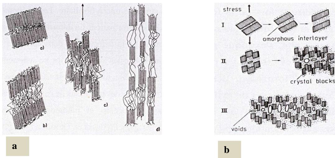
**Figure III.17:** mécanisme de fragmentation des lamelles cristallines :
