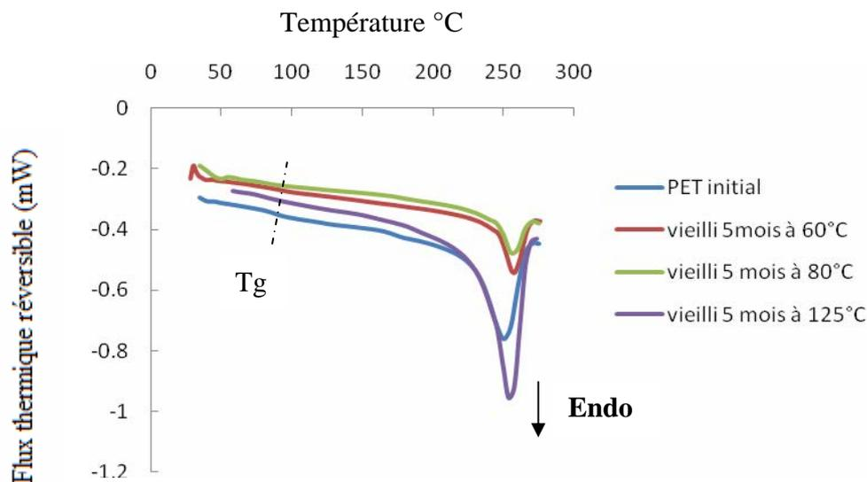
**Figure III.39** : thermogramme MDSC du flux thermique réversible
