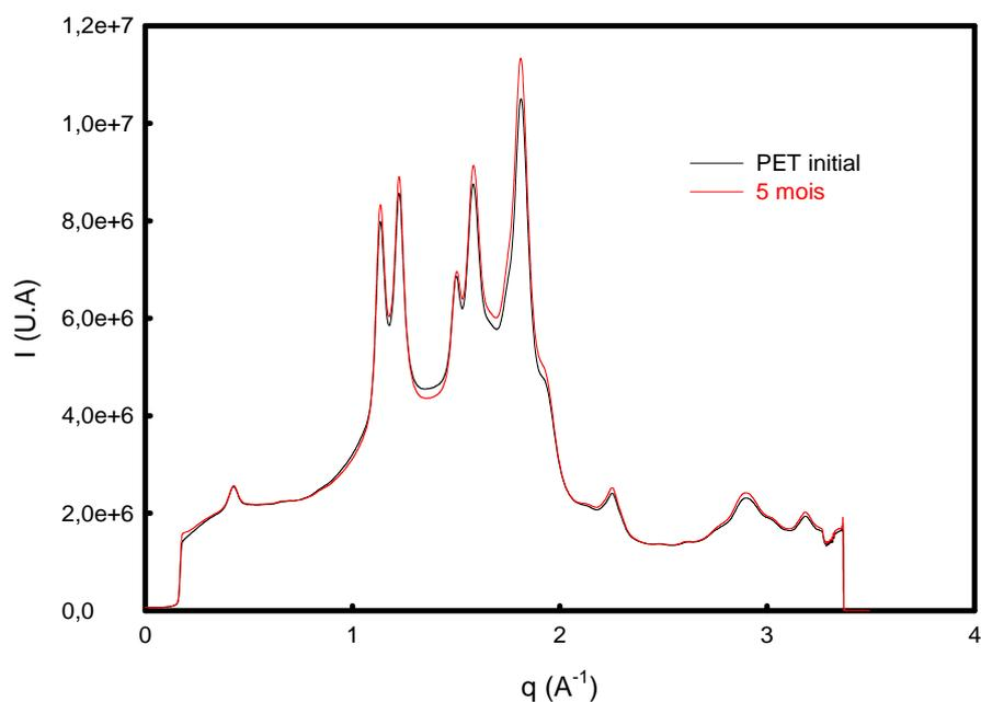
**Figure III.64** : diffractogrammes WAXS du PET vieilli à 125°C
