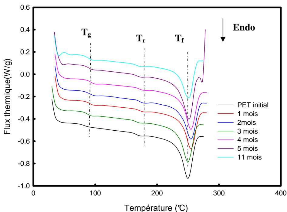
Figure III.30 : courbes DSC de PET vieillis à 60°C
