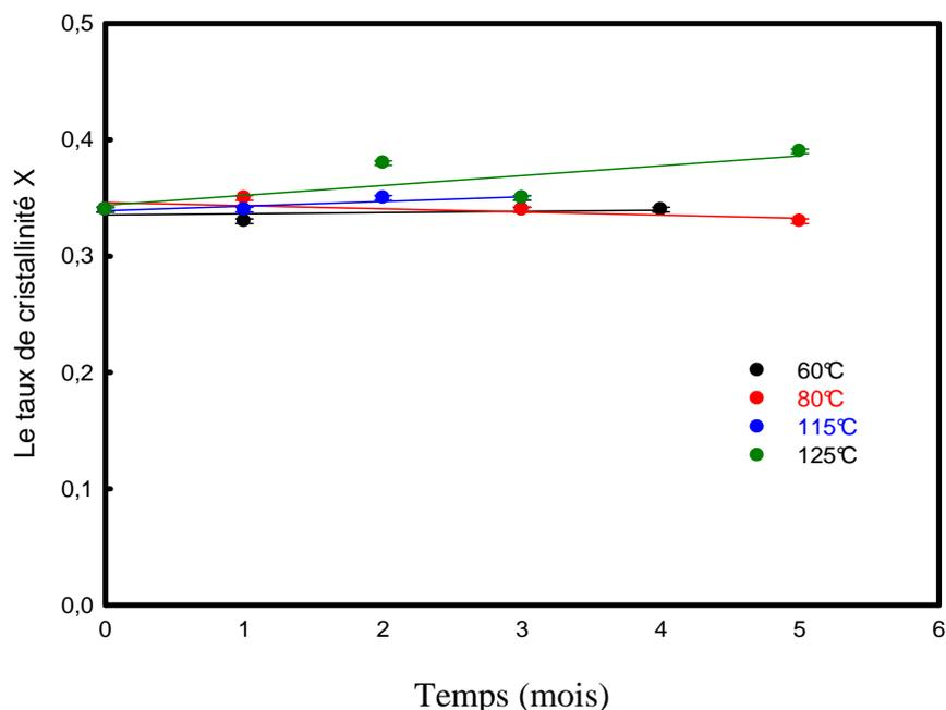
**Figure III.65:** évolution du taux de cristallinité durant le vieillissement thermique du PET calculé à partir des résultats WAXS.
