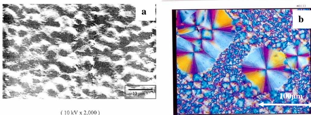
**Figure I.5:** a : microstructure du PET après cristallisation à 120°C (Lu et Hay, 2001)
