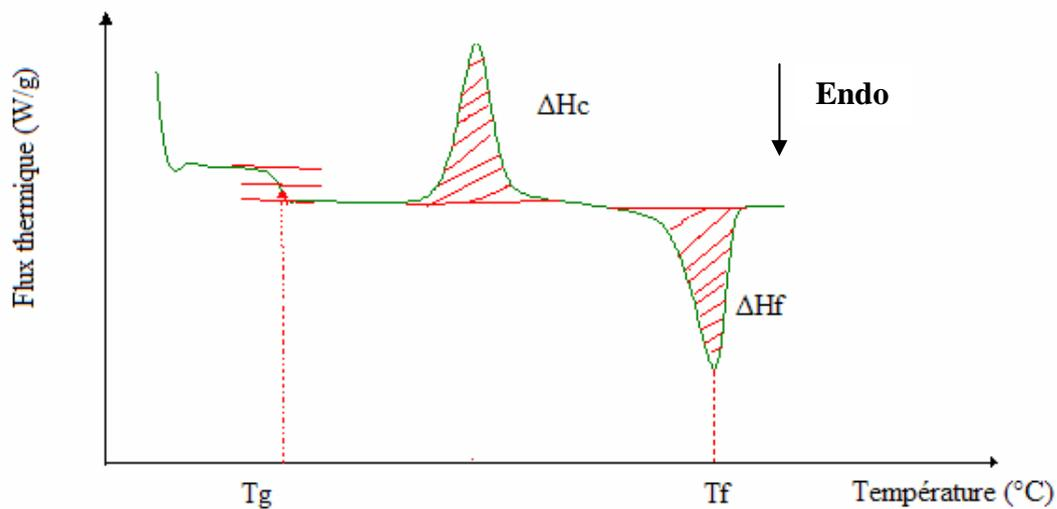
**Figure II.7 :** thermogramme DSC d'un polymère semi-cristallin
