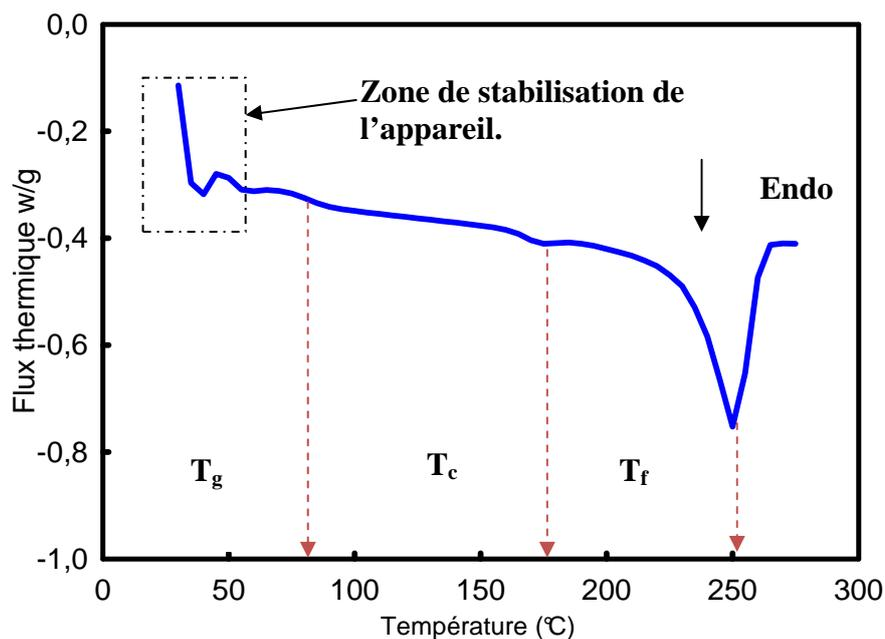
**Figure II.1:** courbe d'enthalpie différentielle : résultats des essais sur le PET reçu.
