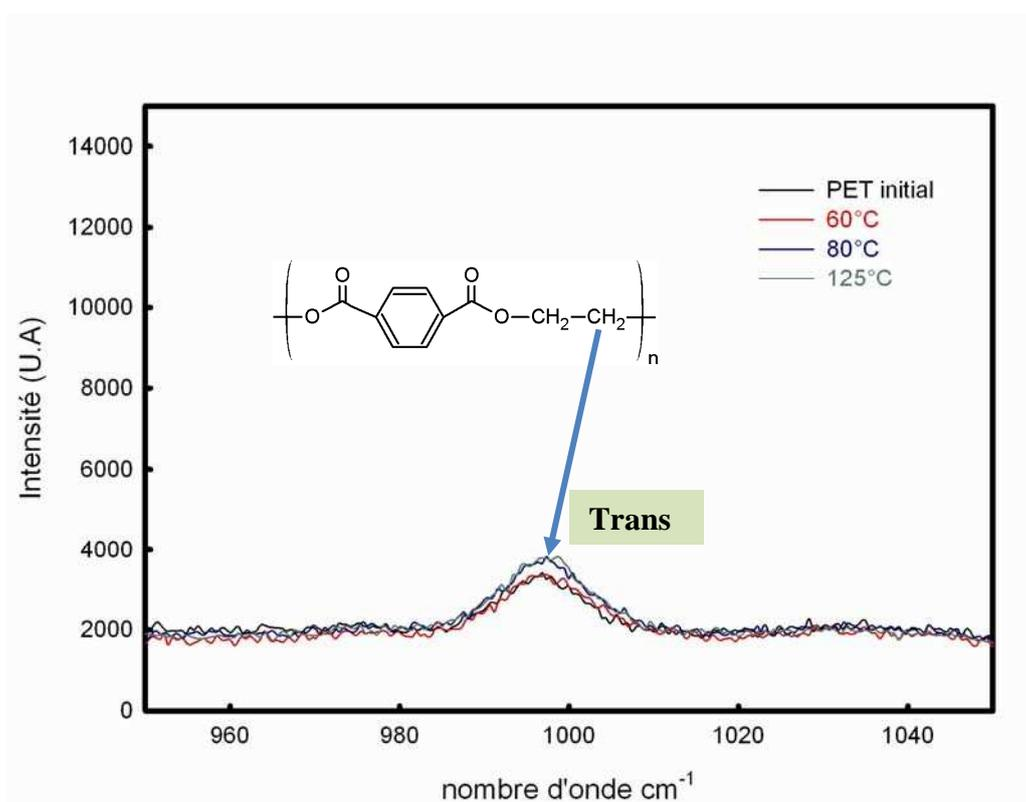
**Figure III.90** : spectre Raman appliqué au PET vieilli 5 mois :  $\nu=995$ , conformation *trans*
