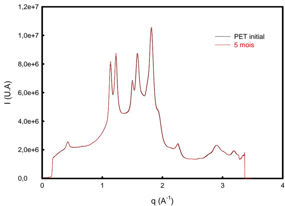
**Figure III.62 :** diffractogrammes WAXS du PET vieilli à 80°C
