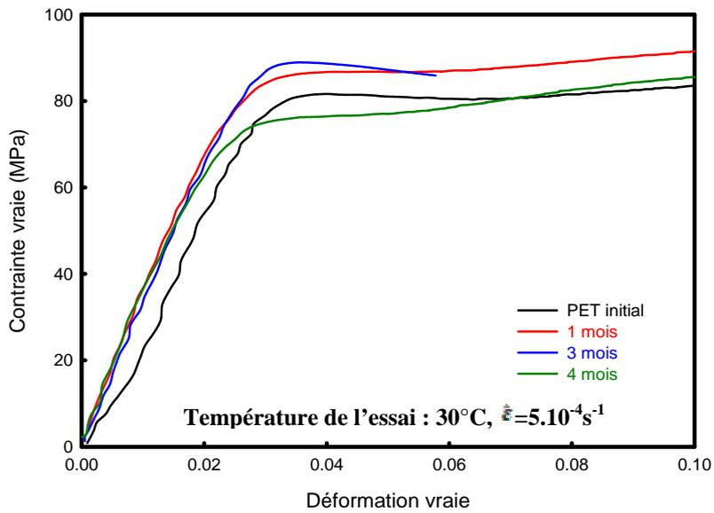
**Figure III.75** : courbes de traction dans la zone de faible déformation pour le PET vieilli à 115°C.
