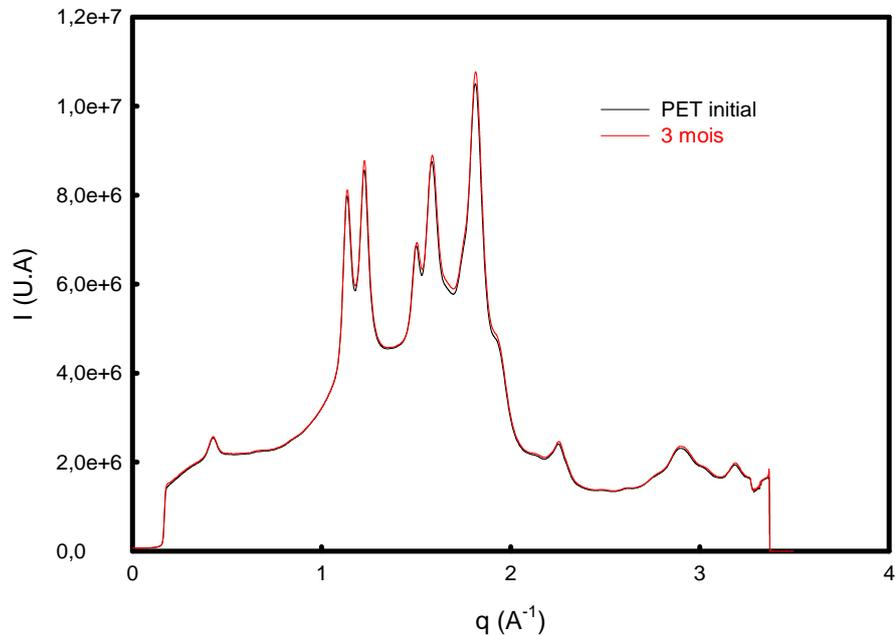
**Figure III.63** : diffractogrammes WAXS du PET vieilli à 115°C
