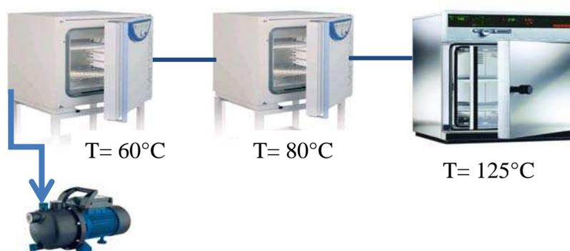
**Figure II.3:** schéma de l'installation du vieillissement du PET
