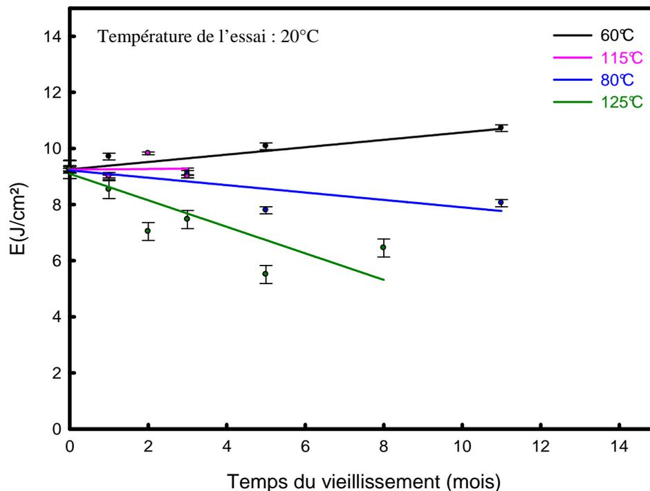
**Figure III.83:** évolution de la fragilité du PET en fonction du temps mesurée par le test de CHARPY
