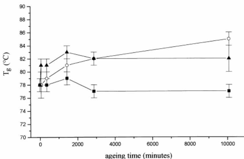
**Figure 1.12:** évolution de la T<sub>g</sub> du PET vieilli à (■) 40°C, (○) 60°C, (▲) 70°C (McGonile *et al.* 1999).
