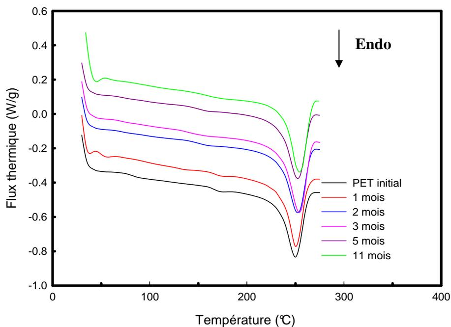
**Figure III.33:** courbes DSC de PET vieilli à 125°C.
