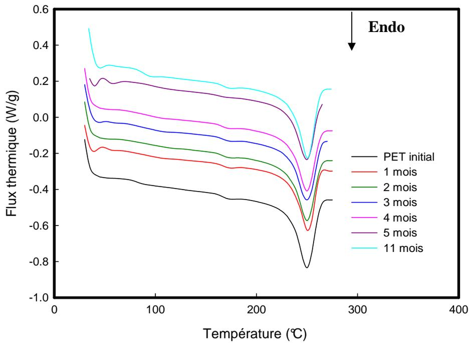
Figure III.31 : courbes DSC de PET vieillis à 80°C.
