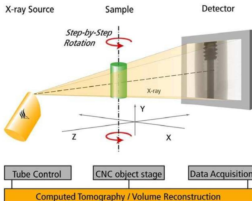
**Figure II.14** : illustration schématique du tomographe
