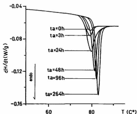
**Figure I.11:** évolution des pics endothermiques du PET mesuré par DSC, (X=3%) maintenu à 60°C pendant différents temps  $t_a$ . La vitesse de chauffe est 2,5K/min (McGonile *et al.* 1999).
