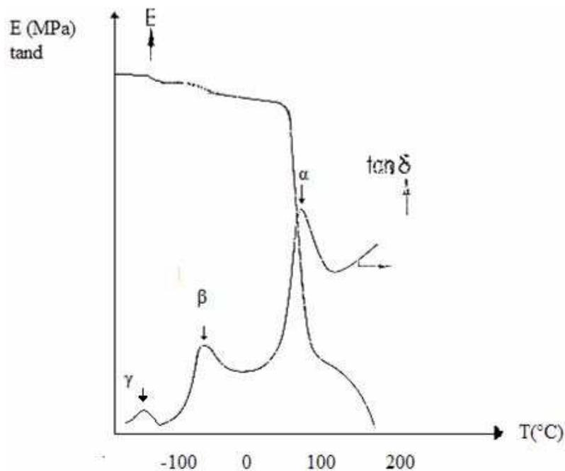
**Figure II.11** : allure générale des thermogrammes DMA d'un matériau polymère à l'état amorphe.
