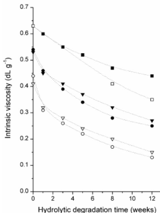
**Figure I.13:** évolution de la viscosité intrinsèque en fonction du temps de l'hydrolyse du PET à 25°C: (■) amorphe, (□) semi cristallin. (Les autres symboles concernent des PET à différents pourcentage de nitrates) (Darwin P.R *et al.*, 2002)
