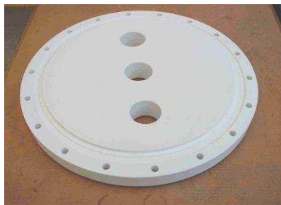
Figure 2 : image d'un support en PET, de conducteurs électriques présents dans les disjoncteurs Haute Tension (Areva T&D).
