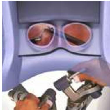
**FIGURE 1.1.** *Système de vision binoculaire (Intuitive Surgical ©)*
