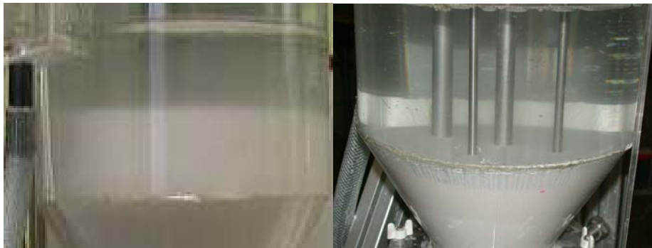
Figure V. 19: Photographies des zones de clarification à 60°C: dispositif à une alimentation (gauche) ; dispositif à double alimentation (droite)
