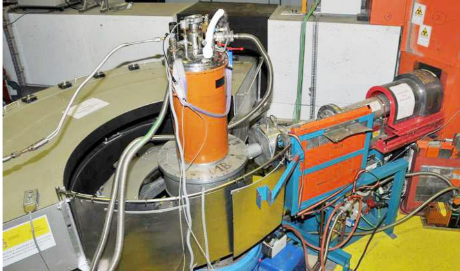
Figure I.4 : Photographie du diffractomètre D1b, équipé du cryostat orange, à l'ILL [13].
