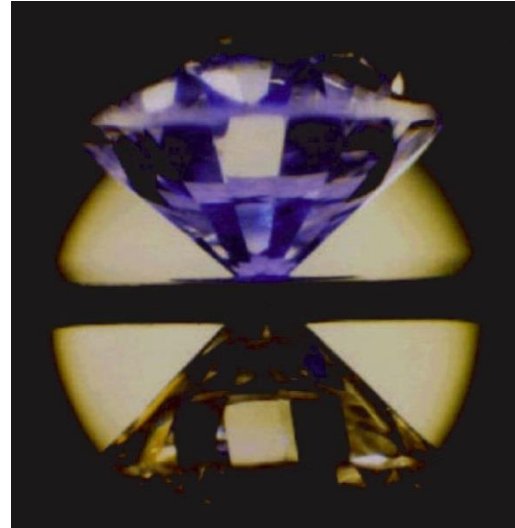
Figure I.7 : Principe du dispositif à enclumes de diamant de la ligne MS-X04SA au synchrotron SLS.
