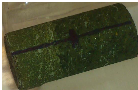
Figure 14 : Éprouvette de minerai intact (2 cm de long) ayant subi une réduction chimique par des sulfures ( H_2S ). La couleur ocre-brune originale a été modifiée.
