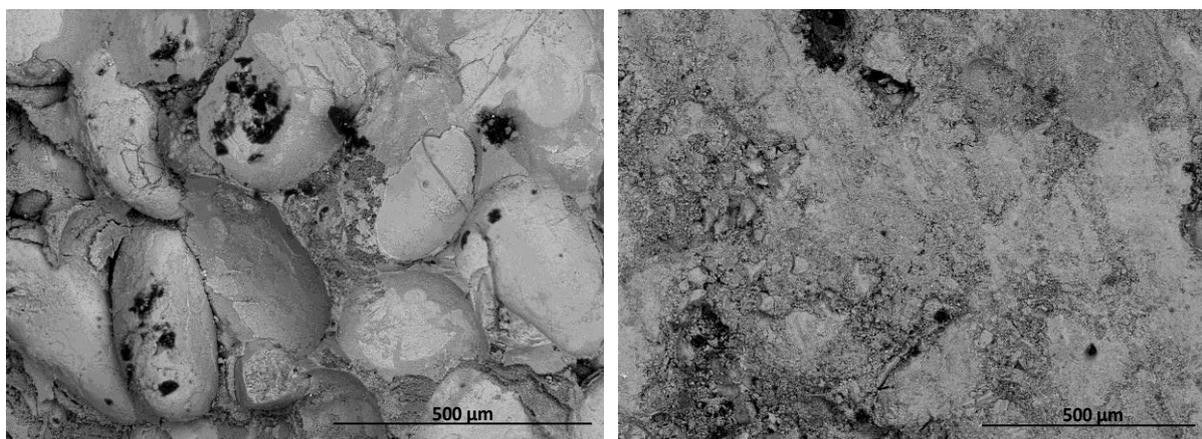
**Figure 15:** Observations en microscopie à balayage d'une fraction brute du minerai intact (à gauche) et de la surface d'une barrette de minerai intact (à droite) La taille du matériau pour créer la barrette rend impossible toute analyse par cette méthode.
