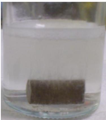
**Figure A2:** Photographie de la réaction entre le peroxyde d'hydrogène et une éprouvette de minerai intact. La présence des bulles indique la forte réaction qui se produit (dégagement de chaleur et augmentation de la pression si le flacon est clos).
