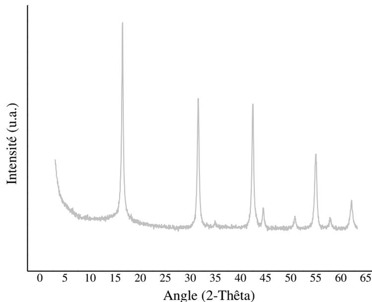
**Figure 3:** Diffractogramme de la lépidocrocite de synthèse.
