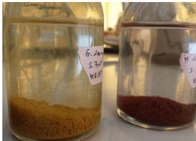
Figure 4: Photographie des flacons de réactions avec les sulfures chimiques avec la goethite (à gauche) et l'hématite naturelle (à droite). Les flocons sont difficiles à disperser, il est donc difficile d'obtenir un aliquot homogène à la seringue.
