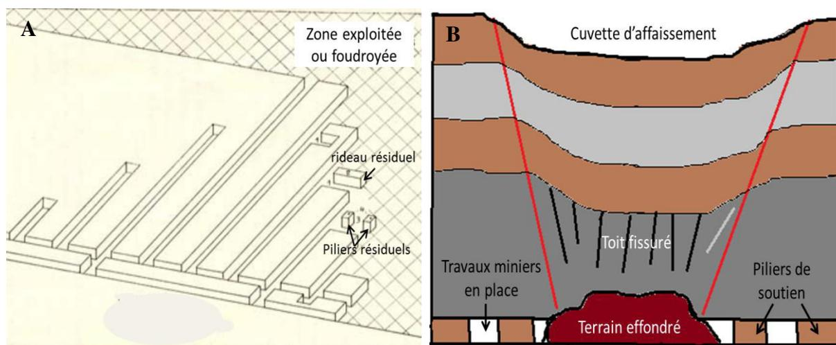
Figure 2.: (A) Schéma d'exploitation par dépilage (Salmo *et al.*, 2006). (B) Schéma d'affaissement suite au dépilage total (modifié de Grgic, 2001), les droites rouges correspondent à l'angle d'influence (par rapport à la verticale). Elles montrent qu'un effondrement faible en profondeur a des conséquences importantes à la surface.
