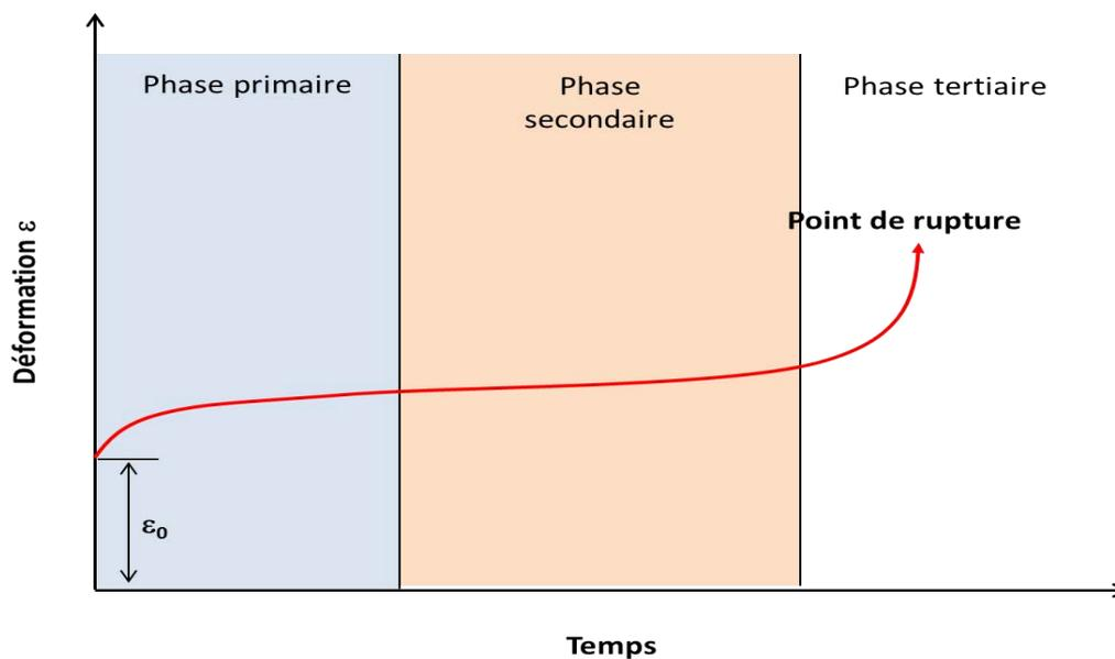
Figure 6 : Courbe schématique d'un essai de fluage montrant les trois stades de fluage, d'après Dieter, 1961.  $\epsilon_0$  représente la déformation rapide initiale.
