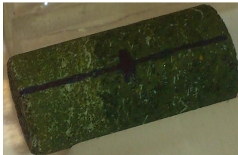
Figure 14 : Éprouvette de minerai intact (2 cm de long) ayant subi une réduction chimique par des sulfures ( H_2S ). La couleur ocre-brune originale a été modifiée.
