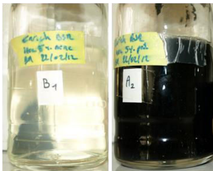
Figure 1: Photographies des flacons d'enrichissement des bactéries sulfato-réductrices. A gauche, le milieu inoculé avec de l'eau de mine (galerie du premier niveau) et à droite, avec l'eau du puits d'aération (-250 m). La formation d'un précipité noir ( \text{FeS} ) caractérise la réduction des sulfates en sulfures, et s'accompagne d'une odeur caractéristique de soufre (œuf pourri).
