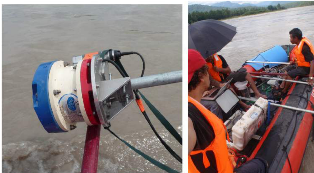
FIGURE 3.2.3 – Adaptation de l'ADCP sur le bateau.
