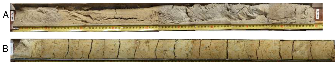
FIGURE 6.2.2 – Exemples de carottes de forage.
