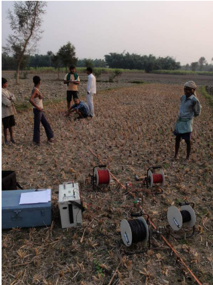
FIGURE 3.2.5 – Dispositif de sondage électrique vertical utilisé pour la détermination des dépôts sédimentaires de sub-surface.
