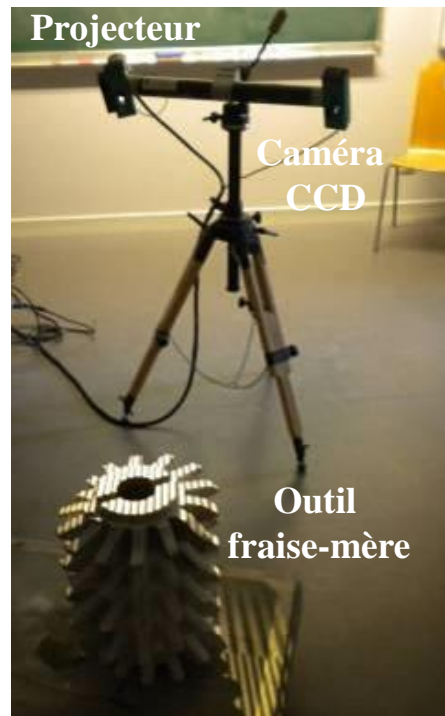
Figure 2.2. Numérisation de l'outil de coupe fraise mère par lumière structurée.
