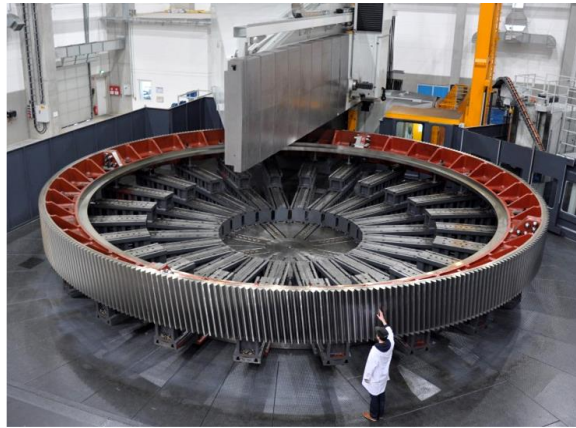
Figure 1.17. Exemple d'une machine de taillage pour les grandes couronnes, (Source Ferry capitain).
