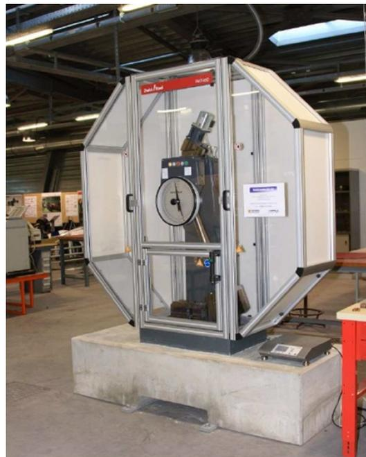
FIGURE 3.15 – Pendule Charpy RKP 450 utilisé au LabPS.
