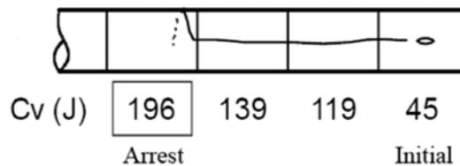
FIGURE 2.27 – Essai d'éclatement à ténacité incrémentale [115].
