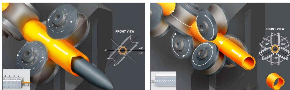
FIGURE 3.3 – Processus du laminage à chaud.
