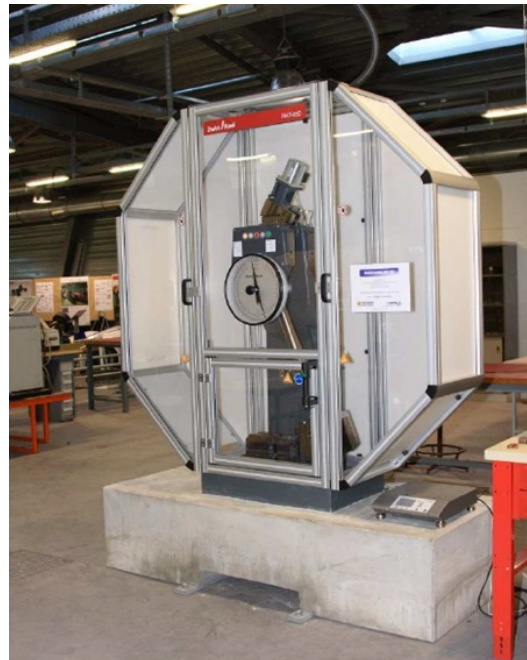
FIGURE 3.15 – Pendule Charpy RKP 450 utilisé au LabPS.
