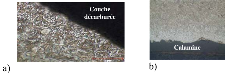
Figure 6 : Sans revêtement, on observe une forte décarburation de la surface (a) qui conduit à une dégradation du comportement en fatigue, de plus le traitement thermique provoque la formation de calamine (b)
