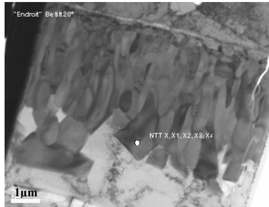
Figure 36 : Micrographie MET de la couche d'interface supérieure supposée \tau_5 avec les points d'analyse EDS correspondants
