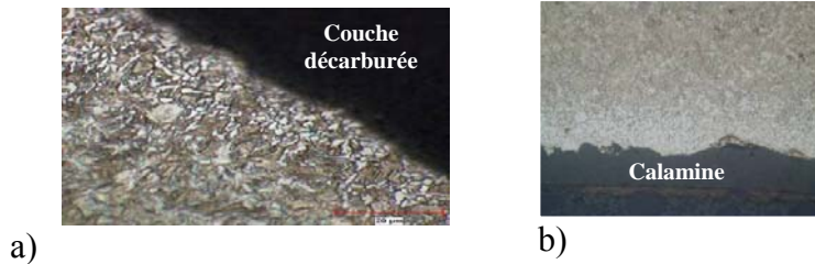
Figure 6 : Sans revêtement, on observe une forte décarburation de la surface (a) qui conduit à une dégradation du comportement en fatigue, de plus le traitement thermique provoque la formation de calamine (b)
