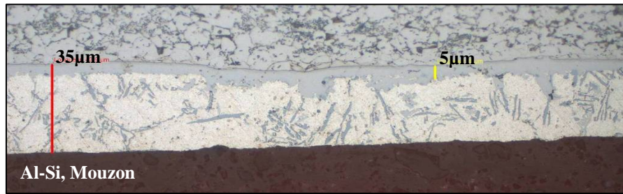
Figure 142 : Etat de livraison de l'Al-Si Mouzon en coupe transverse au microscope optique
