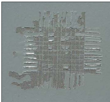
Très mauvaise adhérence peinture Indiana Harbor
