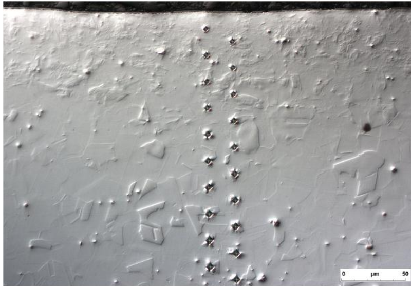
Figure 62 : Filiation de microdureté en zig zag sur coupe sens transverse observé au microscope optique (échantillon grenailé en condition R12 11 ).
