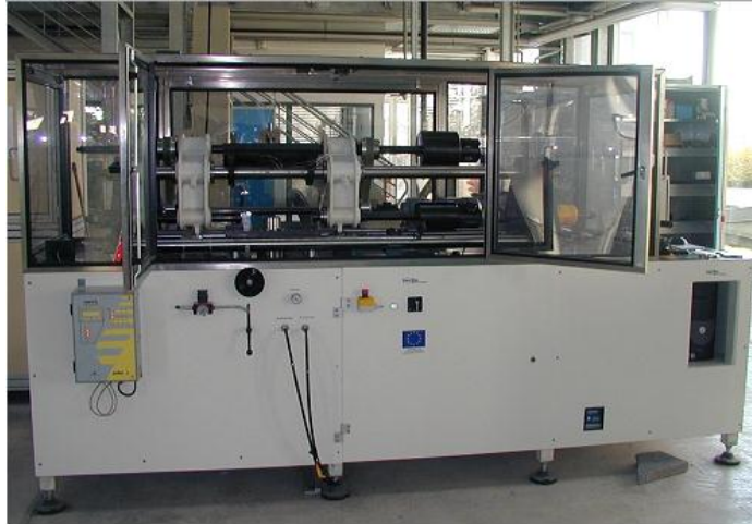
Figure 52 : Grenailleuse de type « SMAT » utilisée par l'UTT.
