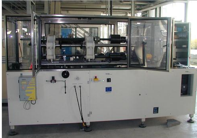
Figure 52 : Grenailleuse de type « SMAT » utilisée par l'UTT.
