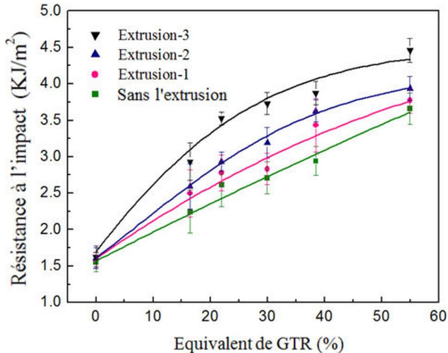
Figure 2 - Résistance à l'impact du GTR-g-PS/PS après l'extrusion.
