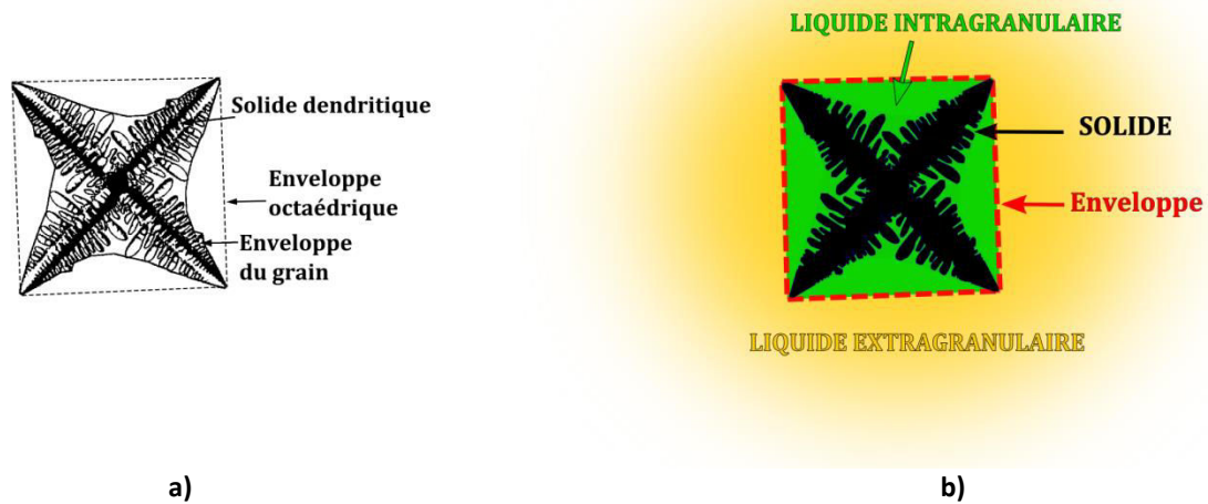
Figure II.2-3 : Schéma d'un grain équiaxe en 2D. a) : Notion d'enveloppe, reliant les pointes des bras primaires et secondaires et comparaison avec l'enveloppe octaédrique utilisée dans SOLID. b) : Illustration des phases solide (en noir), liquide intragranulaire (en vert) et liquide extragranulaire (en jaune-orangé).
