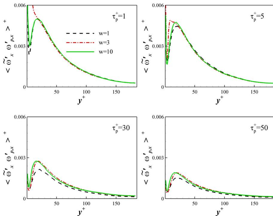
Figure 7.32 - Composante longitudinale de la covariance des vitesses angulaires fluide-particule.
