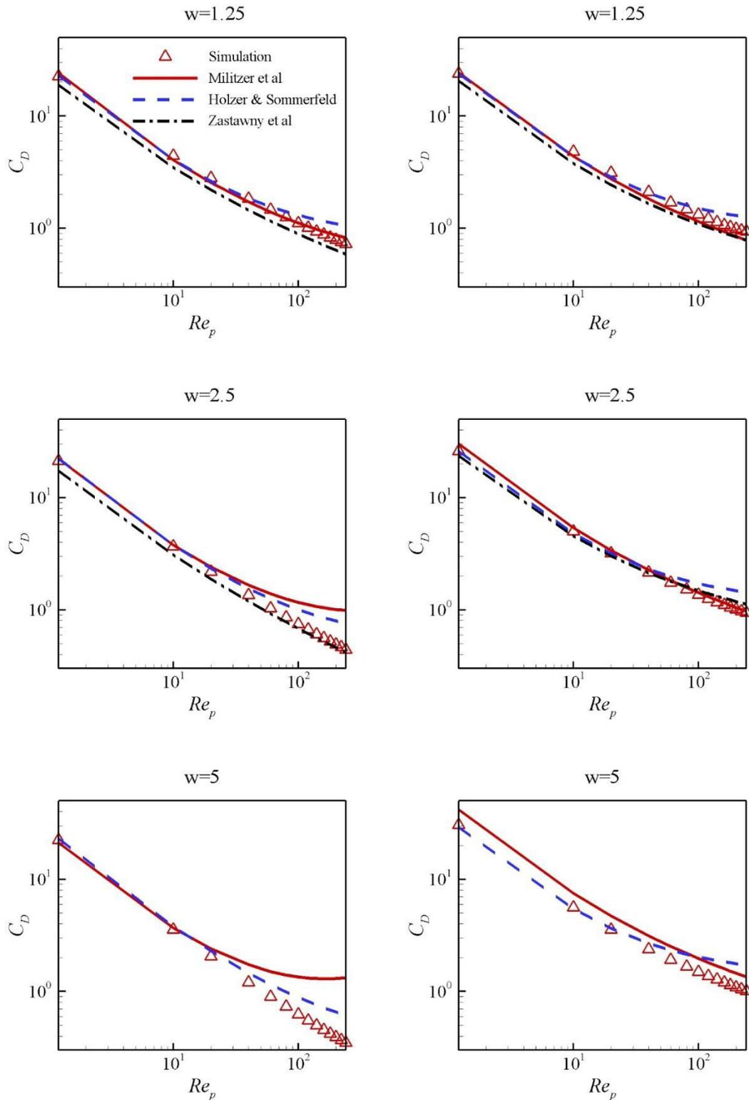
Figure 3.2 - Coefficient de traînée en fonction du nombre de Reynolds particulaire comparés aux corrélations proposées dans la littérature pour les rapports d'aspect  $w = 1.25$ ,  $w = 2.5$  et  $w = 5$ . A gauche les résultats pour  $\alpha = 0^\circ$  et à droite les résultats pour  $\alpha = 90^\circ$ .
