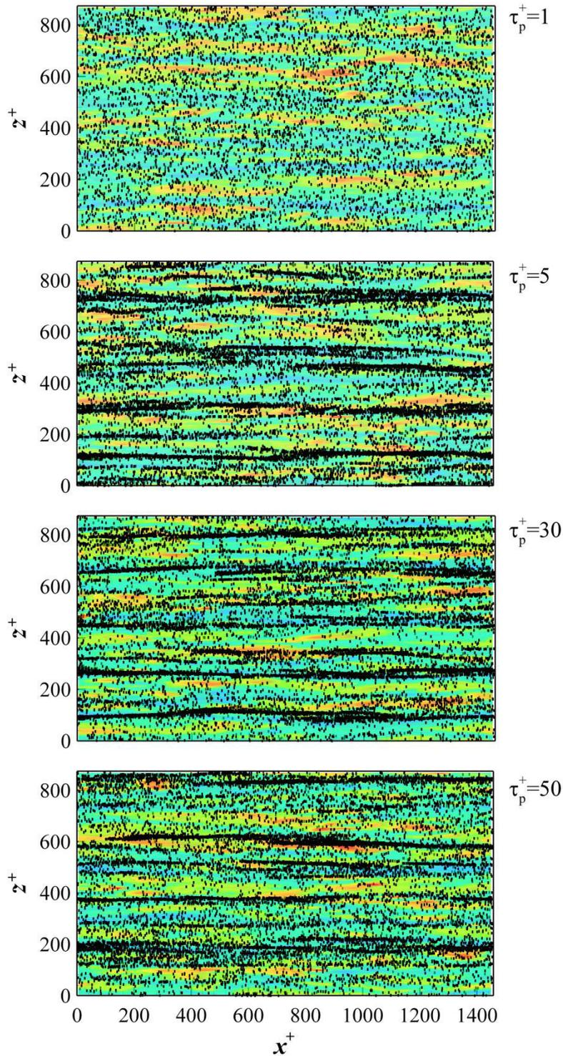
Figure 6.3 - Distribution instantanée des particules ellipsoïdales de rapport d'aspect  $w=10$ , dans une tranche parallèle aux parois et située dans l'intervalle  $1 < y^+ < 5$ . La phase fluide est représentée par les contours de fluctuations de la vitesse longitudinale dans le plan située  $y^+ = 5$ . Zones en bleu :  $u'_x < 0$ , zones en rouge :  $u'_x > 0$ .
