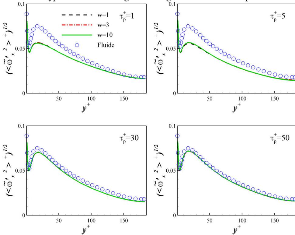
Figure 6.28 - Ecart type de la vitesse angulaire longitudinale du fluide porteur et du fluide vu.
