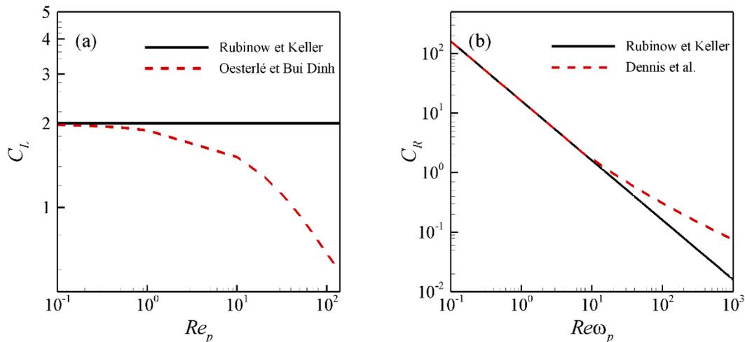
Figure 1.4 - (a) : Evolution du coefficient de portance en fonction du nombre de Reynolds (b) : Evolution du coefficient de couple en fonction du nombre de Reynolds angulaire.
