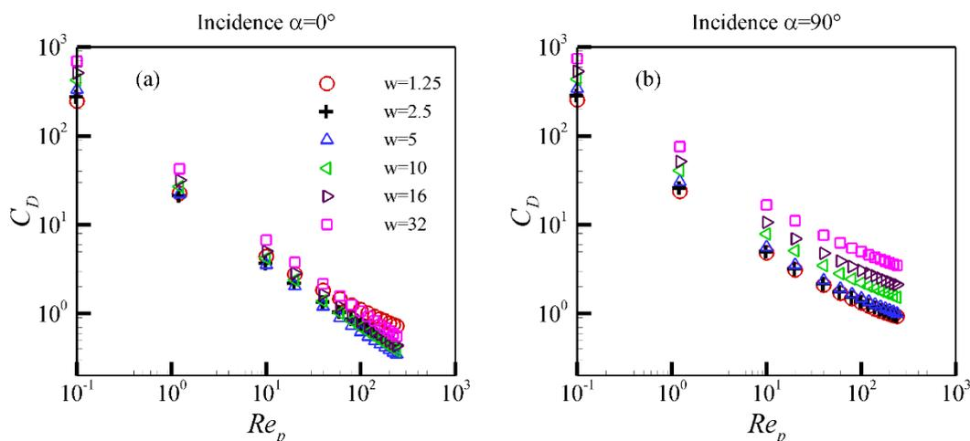
Figure 3.1 - Coefficient de traînée en fonction du nombre de Reynolds particulaire.
