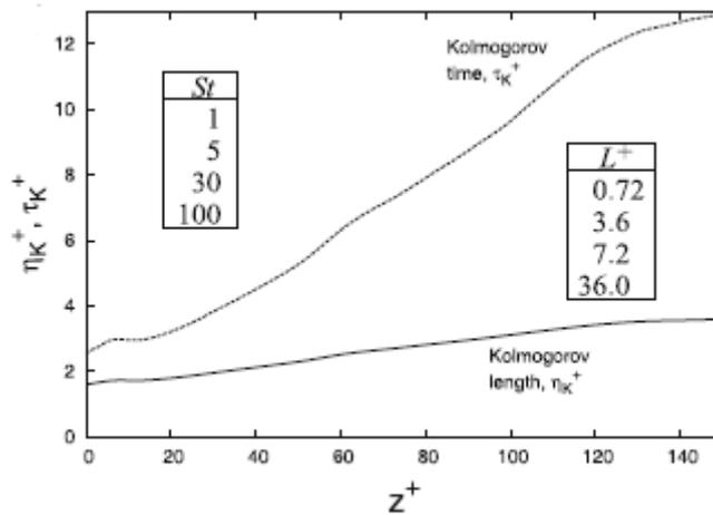
Figure 4.6 - Evolution des échelles spatiale ( $\eta_k^+$ ) et temporelle ( $\tau_k^+$ ) de turbulence dans le canal.  $L^+$  et  $St \approx \tau_p^+$  représentent respectivement la taille des particules et le nombre de Stokes. Figure issue de Marchioli & Soldati (2013).
