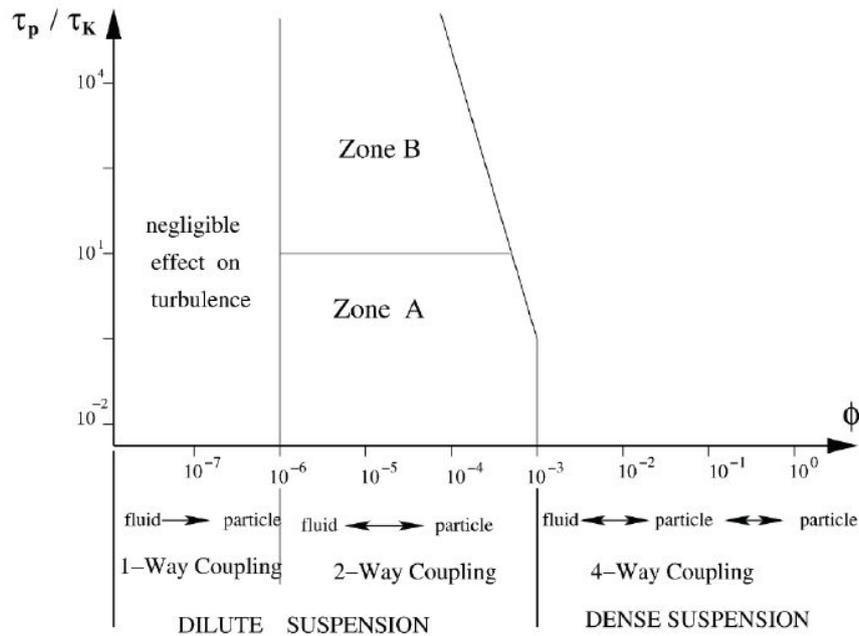
Figure 4.5 - Classification des interactions en fonction de la fraction volumique  $\Phi$  et de  $\tau_p / \tau_k$ .  $\tau_p$  et  $\tau_k$  représentent respectivement le temps de relaxation de la particule et la plus petite échelle temporelle de turbulence. Figure issue de Elgobashi (1994).
