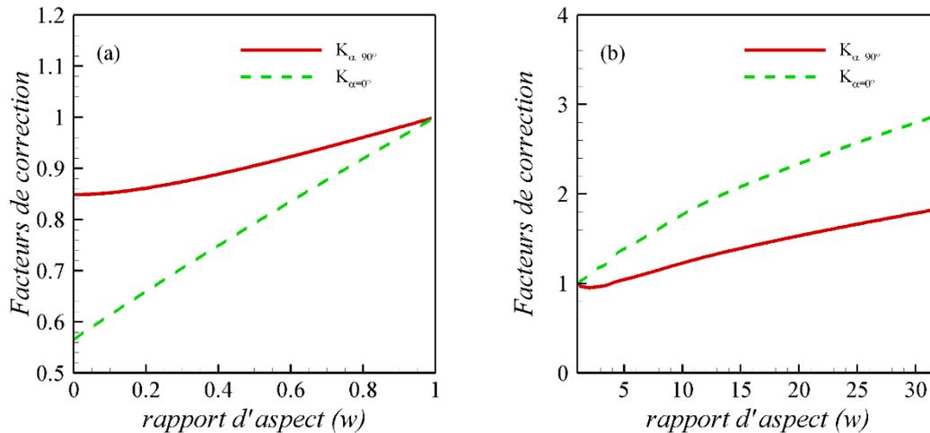
Figure 1.5 - Evolution des coefficients de correction de Brenner  $K_{\alpha=0^\circ}$  et  $K_{\alpha=90^\circ}$  en fonction du rapport d'aspect  $w$ . (a) : ellipsoïdes aplatis et (b) : ellipsoïdes allongés.
