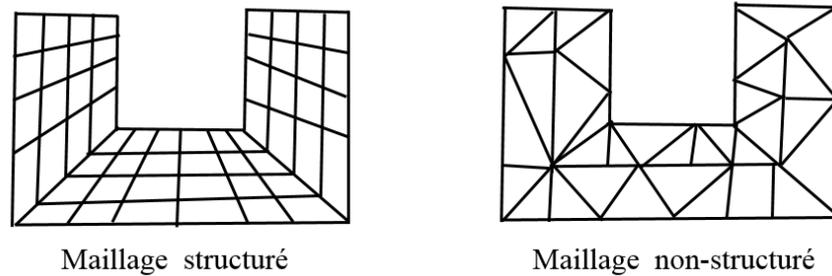
Figure 2.4 - Exemple de maillage structuré et non-structuré.
