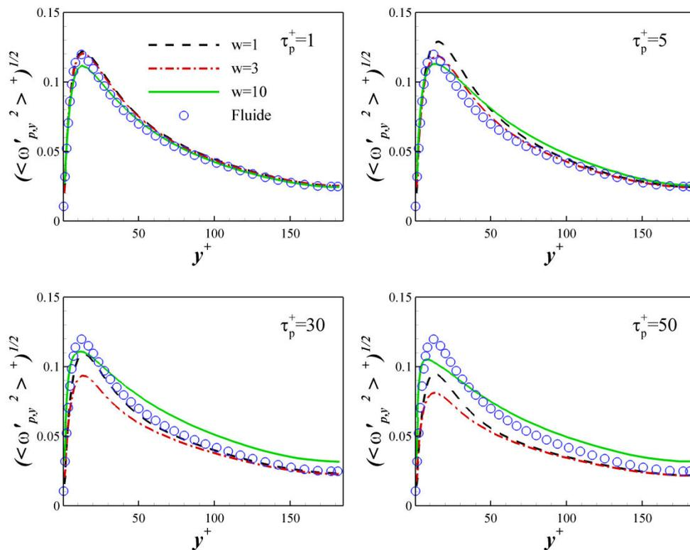
Figure 6.29 - Ecart type de la vitesse angulaire normale aux parois du fluide porteur et des particules.
