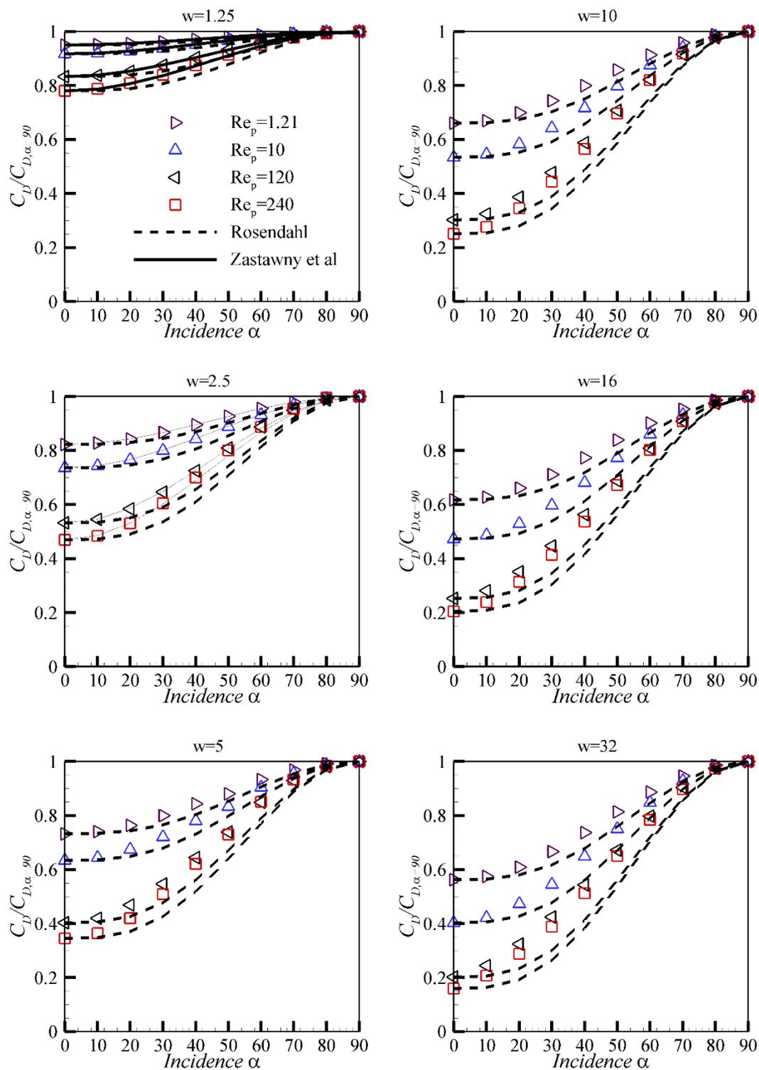
Figure 3.4 - Coefficient de traînée normalisé  $C_D/C_{D,\alpha=90}$  en fonction de l'angle d'incidence comparé aux formulations normalisées de Rosendahl (2000) et Zastawny *et al.* (2012).
