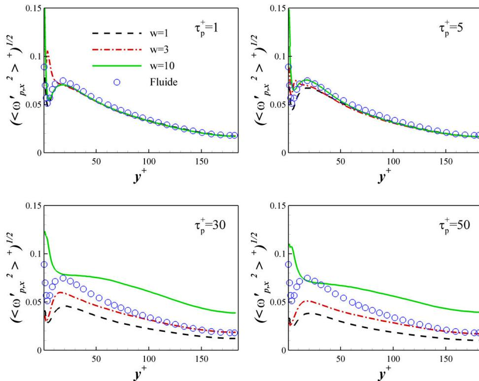
Figure 7.26 - Ecart type de la vitesse angulaire longitudinale des particules.
