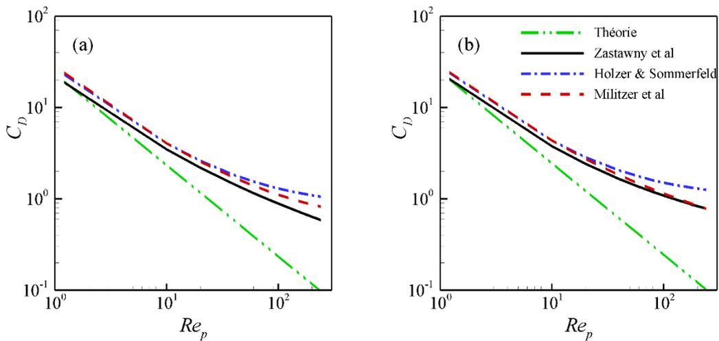
Figure 1.8 - Comparaison des différentes corrélations du coefficient de traînée pour  $w = 1.25$ . (a) : Coefficient de traînée pour  $\alpha = 0^\circ$ . (b) : Coefficient de traînée pour  $\alpha = 90^\circ$ .
