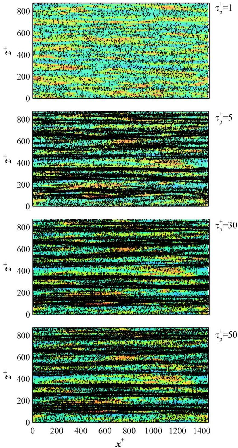
Figure 7.2 - Distribution instantanée des particules sphériques situées dans une tranche parallèle aux parois et situées dans l'intervalle  $1 < y^+ < 5$ . La phase fluide est représentée par les contours de fluctuations de la vitesse longitudinale dans le plan située  $y^+ = 5$ . Zones en bleu :  $u'_x < 0$ , zones en rouge :  $u'_x > 0$ .
