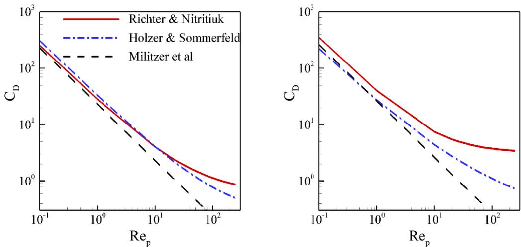
Figure 1.9 - Comparaison des différentes corrélations du coefficient de traînée pour  $w = 2$ . (a) : Coefficient de traînée pour  $\alpha = 0^\circ$ . (b) : Coefficient de traînée pour  $\alpha = 90^\circ$ .
