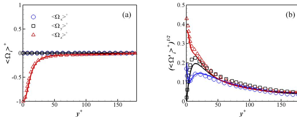
Figure 5.7 - (a) : Moyenne de la vorticité et (b) : Ecarts types de la vorticité. Les symboles et les lignes continues représentent respectivement les résultats de notre simulation et les résultats de Moser *et al.* (1999).
