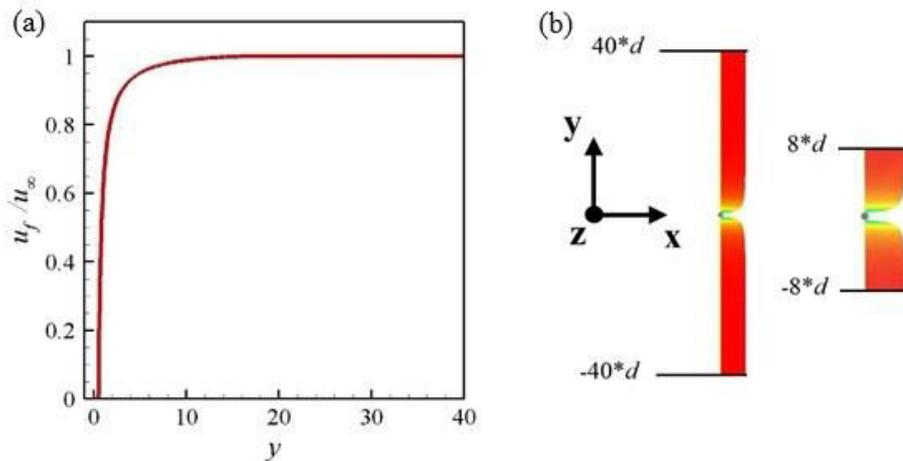
Figure 2.6 - Evolution du rapport  $u_f/u_\infty$  en fonction de la hauteur de la boîte fluide (a) et profil des vitesses sur une ligne perpendiculaire à l'écoulement moyen (b) avec un zoom sur la zone  $d \in [-8, 8]$ .
