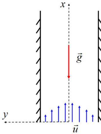
Figure 7.1 - Schéma représentatif d'un écoulement vertical ascendant.
