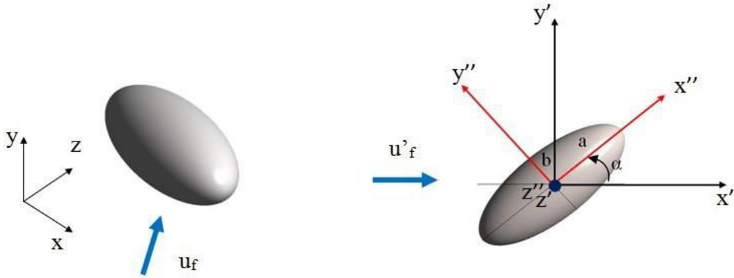
Figure 1.2 - Configuration 3D de l'écoulement dans le repère inertiel  $(x, y, z)$  à gauche et configuration 3D dans le repère de translation  $(x', y', z')$  et le repère de rotation  $(x'', y'', z'')$  à droite. L'angle d'incidence  $\alpha$  est défini comme l'angle entre la direction de l'écoulement et l'axe de révolution de l'ellipsoïde.  $u_f$  et  $u'_f$  représentent respectivement la vitesse du fluide dans le repère inertiel  $(x, y, z)$  et le repère de translation  $(x', y', z')$ .
