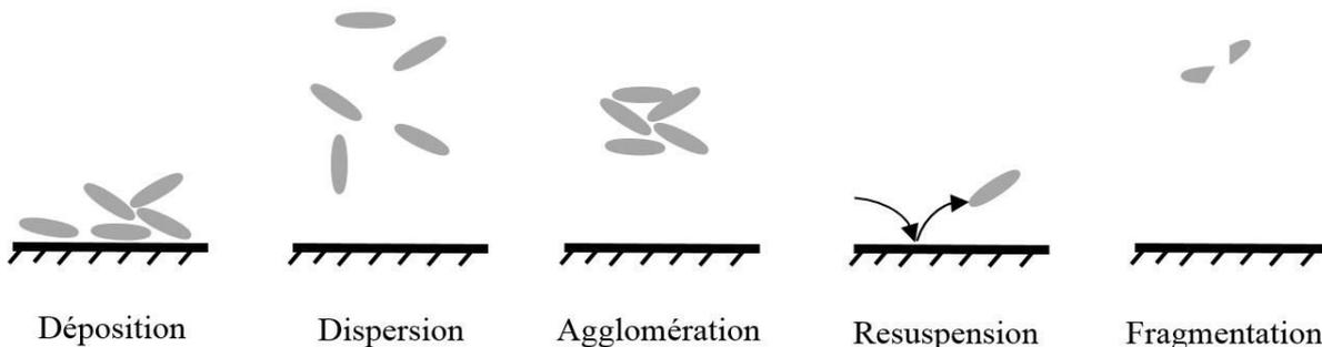
Figure 4.1 - Illustration des différents phénomènes physiques qui apparaissent dans le transport de particules solides.
