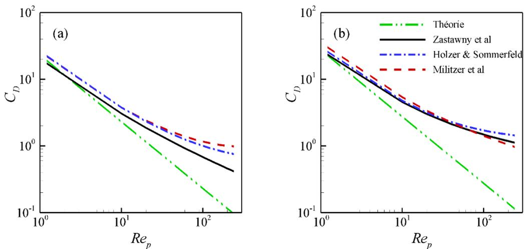
Figure 1.10 - Comparaison des différentes corrélations du coefficient de traînée pour  $w = 2.5$ . (a) : Coefficient de traînée pour  $\alpha = 0^\circ$ . (b) : Coefficient de traînée pour  $\alpha = 90^\circ$ .
