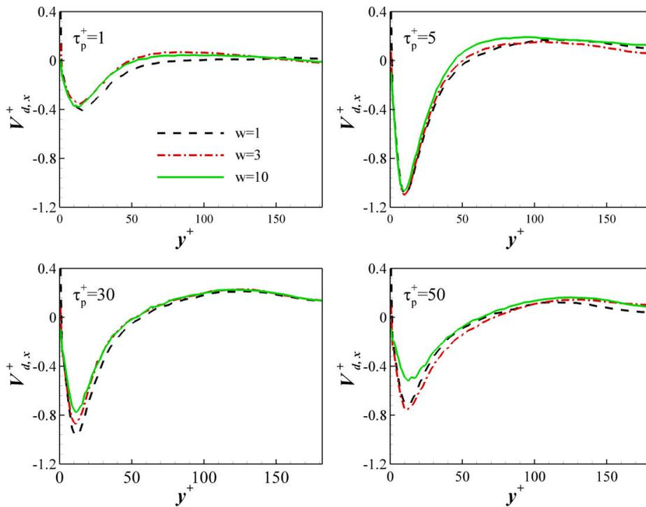
Figure 6.9 - Vitesse moyenne de dérive longitudinale.
