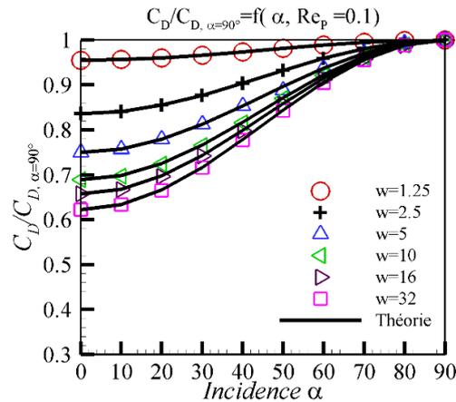
Figure 2.9 - Coefficient de traînée normalisé en fonction de l'angle d'incidence, à  $Re_p = 0.1$ , comparé aux résultats théorique normalisés.
