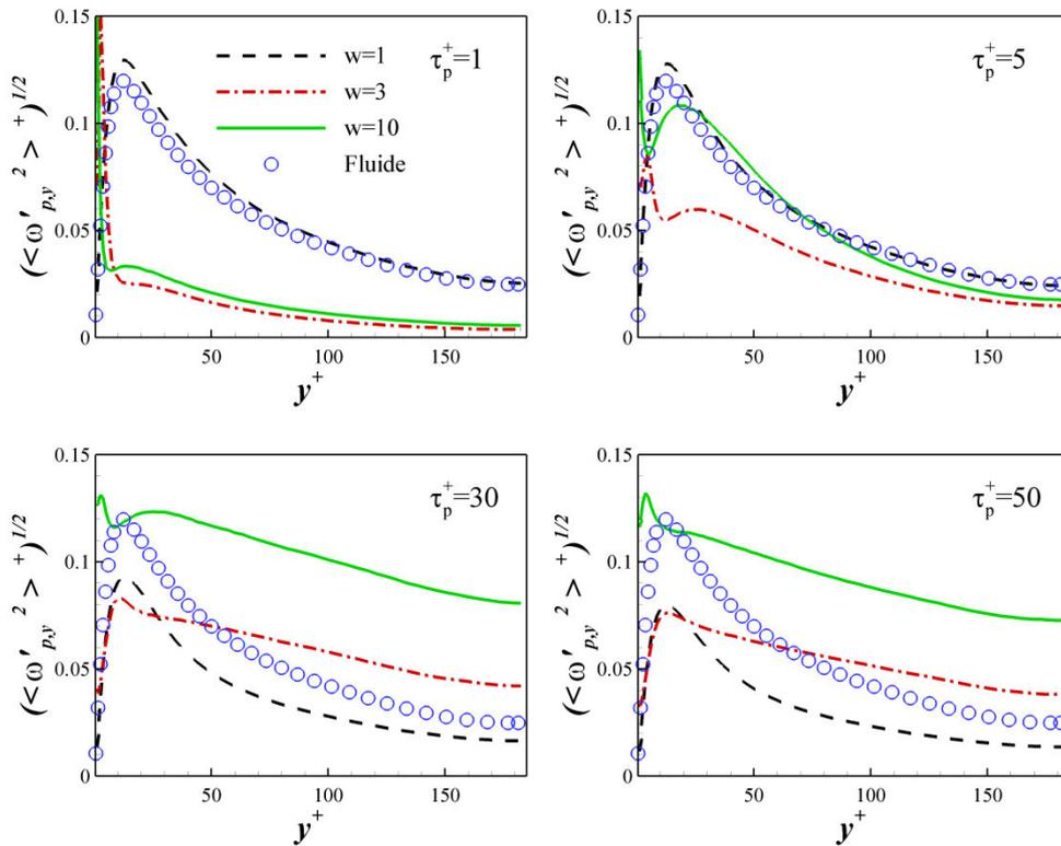
Figure 7.28 - Ecart type de la vitesse angulaire normale à la paroi des particules.
