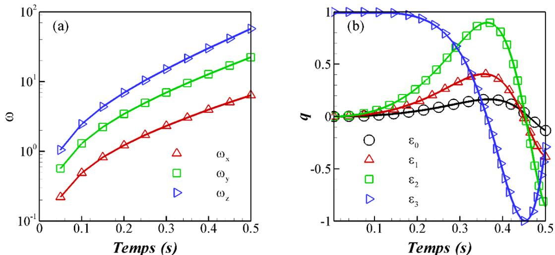
Figure 5.3 - Validation du mouvement de rotation. (a) : comparaison de la vitesse angulaire obtenue par la simulation (symboles) et la solution théorique (Eq : 5.18) (lignes continues). (b) : comparaison entre le quaternion obtenu par la simulation (symboles) et la solution obtenue par Matlab (lignes continues).
