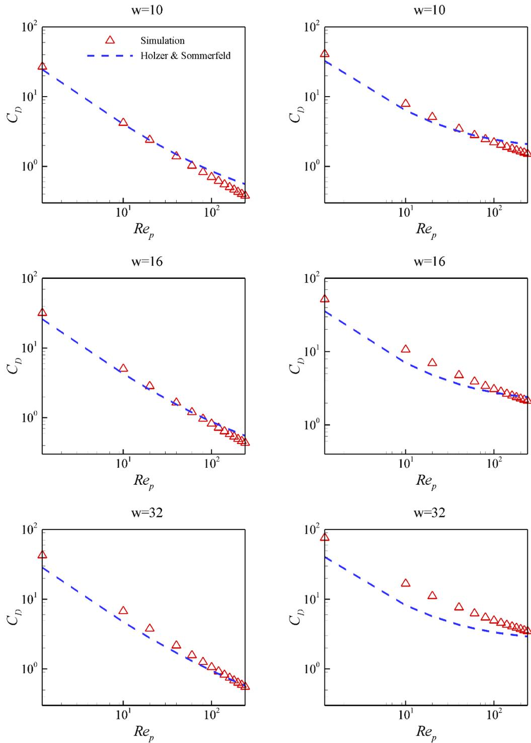
Figure 3.3 - Coefficient de traînée en fonction du nombre de Reynolds particulaire comparés aux corrélations proposées dans la littérature pour les rapports d'aspect  $w = 10$ ,  $w = 16$  et  $w = 32$ . A gauche les résultats pour  $\alpha = 0^\circ$  et à droite les résultats pour  $\alpha = 90^\circ$ .
