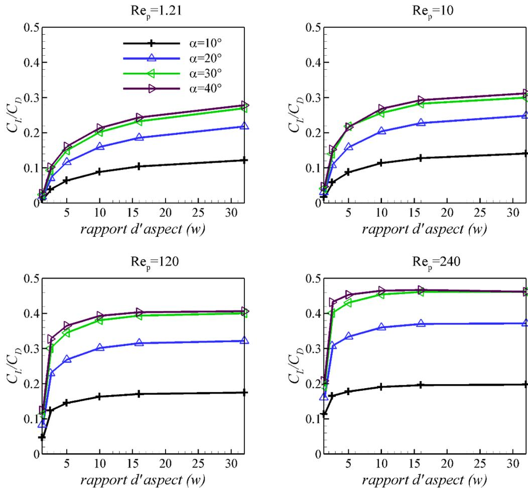
Figure 3.9 - Rapport du coefficient de portance sur le coefficient de traînée en fonction de l'angle d'incidence.
