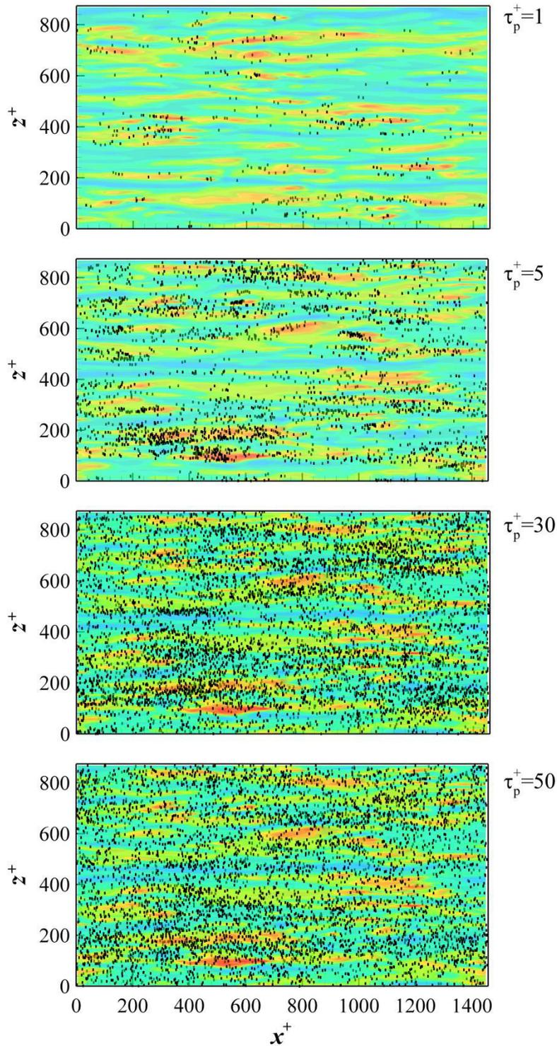
Figure 7.4 - Distribution instantanée des particules ellipsoïdales de rapport d'aspect  $w=10$ , dans une tranche parallèle aux parois et située dans l'intervalle  $1 < y^+ < 5$ . La phase fluide est représentée par les contours de fluctuations de la vitesse longitudinale dans le plan située  $y^+ = 5$ . Zones en bleu :  $u'_x < 0$ , zones en rouge :  $u'_x > 0$ .
