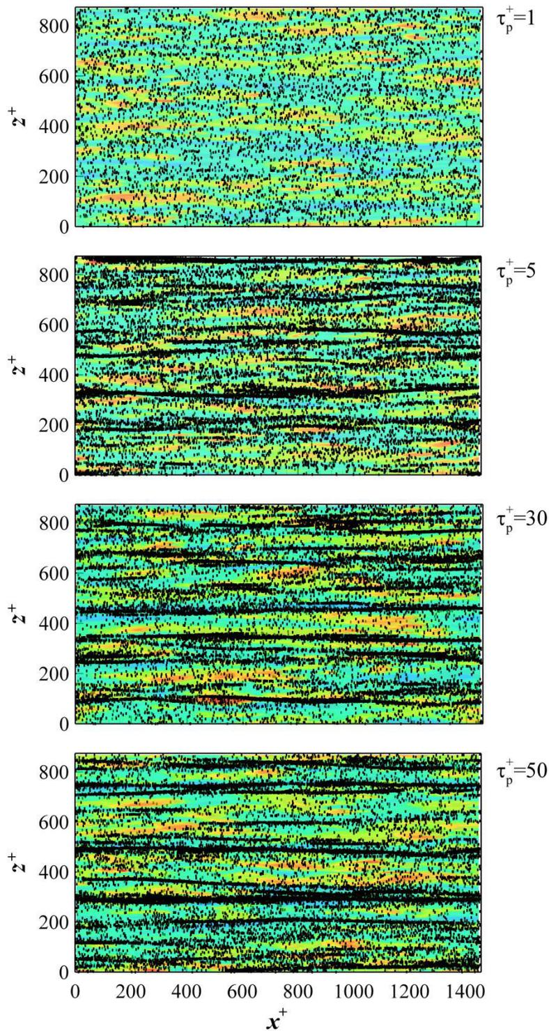
Figure 6.2 - Distribution instantanée des particules ellipsoïdales de rapport d'aspect  $w=3$ , dans une tranche parallèle aux parois et située dans l'intervalle  $1 < y^+ < 5$ . La phase fluide est représentée par les contours de fluctuations de la vitesse longitudinale dans le plan située  $y^+ = 5$ . Zones en bleu :  $u'_x < 0$ , zones en rouge :  $u'_x > 0$ .
