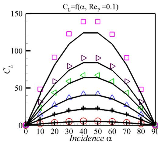
Figure 2.12 - Coefficient de portance en fonction de l'angle d'incidence, à  $Re_p = 0.1$ , comparé aux résultats théoriques (Eq : 1.20). Les symboles correspondent aux rapports d'aspect, (o) :  $w = 1.25$ , (+) :  $w = 2.5$ , ( $\Delta$ ) :  $w = 5$ , ( $\triangleleft$ ) :  $w = 10$ , ( $\triangleright$ ) :  $w = 16$ , ( $\Delta$ ) et (le carré) :  $w = 32$ .
