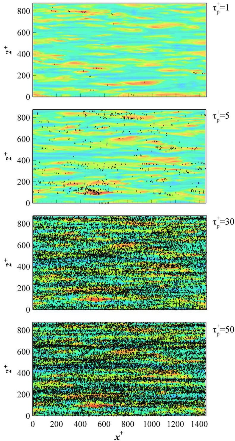
Figure 7.3 - Distribution instantanée des particules ellipsoïdales de rapport d'aspect  $w=3$ , situées dans une tranche parallèle aux parois et située dans l'intervalle  $1 < y^+ < 5$ . La phase fluide est représentée par les contours de fluctuations de la vitesse longitudinale dans le plan située  $y^+ = 5$ . Zones en bleu :  $u'_x < 0$ , zones en rouge :  $u'_x > 0$ .
