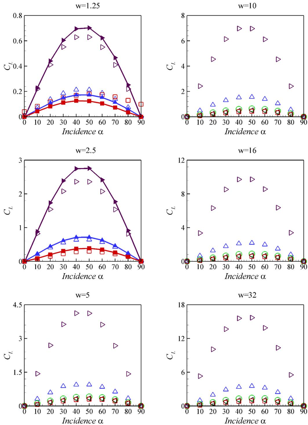
Figure 3.7 - Coefficient de portance en fonction de l'angle d'incidence. Comparaison avec les corrélations de Zastawny *et al.* (2012) (ligne continue avec des symboles pleins). Les symboles vides correspondent aux résultats de simulations. ( $\triangleright$ ) :  $Re_p = 1.21$ , ( $\Delta$ ) :  $Re_p = 10$ , ( $\circ$ ) :  $Re_p = 60$ , ( $\triangleleft$ ) :  $Re_p = 120$  et (le carré) :  $Re_p = 240$ .
