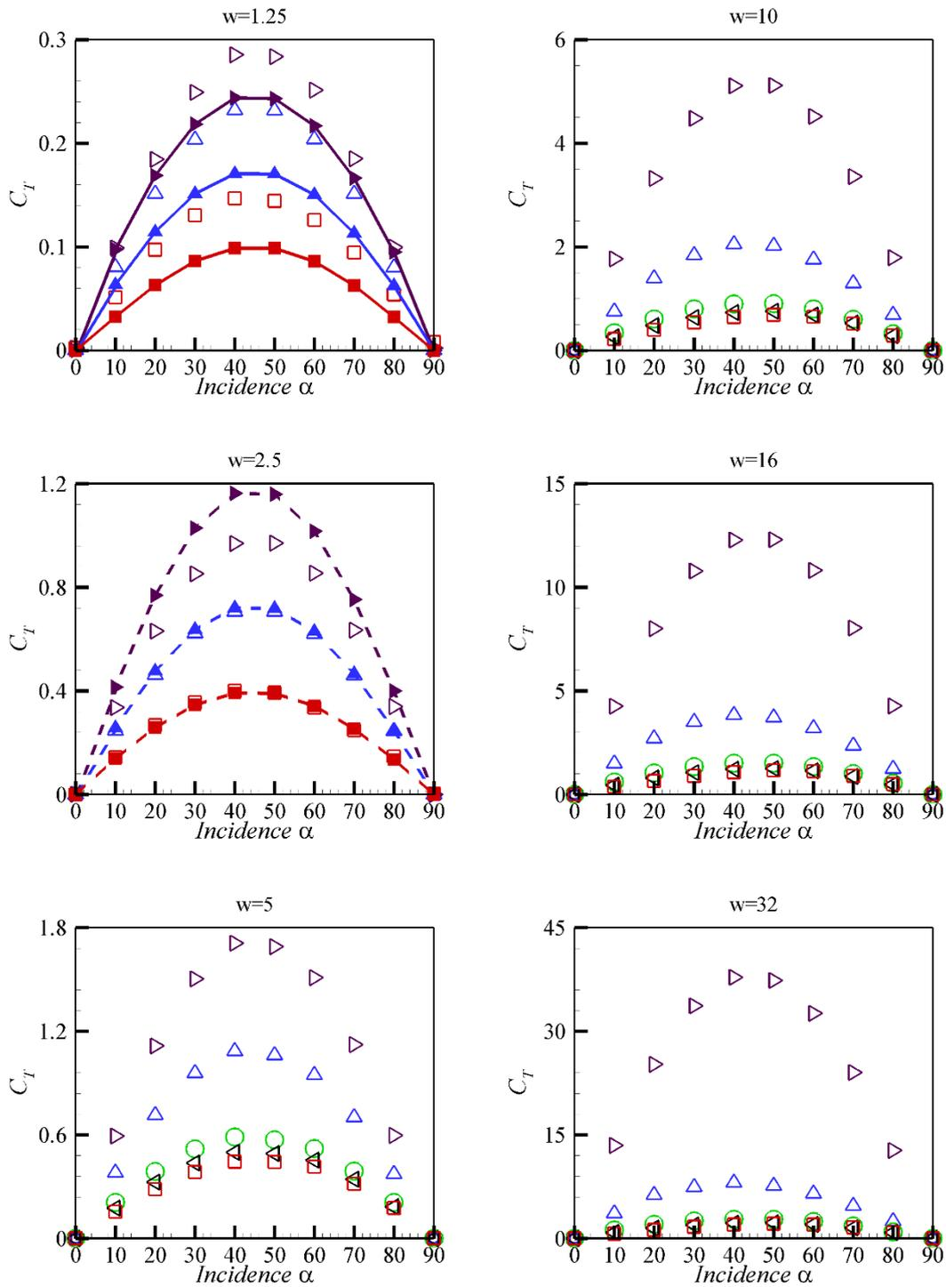
Figure 3.10 - Coefficient du couple de tangage en fonction de l'angle d'incidence. Comparaison avec les corrélations de Zastawny *et al.* (2012) (ligne continue avec des symboles pleins). Les symboles vides correspondent aux résultats de simulations. ( $\triangleright$ ) :  $Re_p = 1.21$ , ( $\Delta$ ) :  $Re_p = 10$ , ( $\circ$ ) :  $Re_p = 60$ , ( $\triangleleft$ ) :  $Re_p = 120$  et (le carré) :  $Re_p = 240$ .
