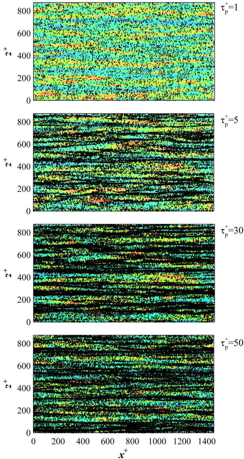
Figure 6.1 - Distribution instantanée des particules sphériques dans une tranche parallèle aux parois et située dans l'intervalle  $1 < y^+ < 5$ . La phase fluide est représentée par les contours de fluctuations de la vitesse longitudinale dans le plan située  $y^+ = 5$ . Zones en bleu :  $u'_x < 0$ , zones en rouge :  $u'_x > 0$ .
