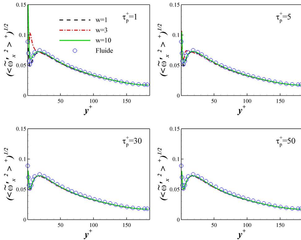
Figure 7.27 - Ecart type de la vitesse angulaire longitudinale du fluide vu.
