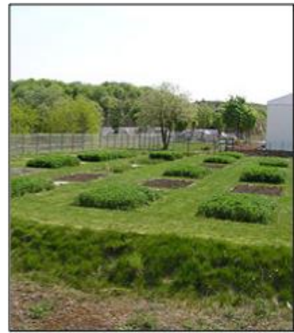
Dispositif expérimental des parcelles lysimétriques sur le site du GISFI (Homécourt, 54)
