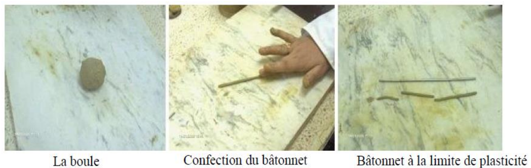
Figure I.11. Détermination de la limite de plasticité.
