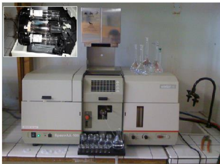
Figure IV.3. Spectroscopie d'absorption Atomique SpectrAA-100 VARIAN
