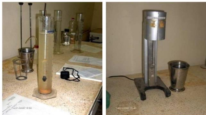
Figure I.17. Analyse granulométrique par sédimentométrie.
