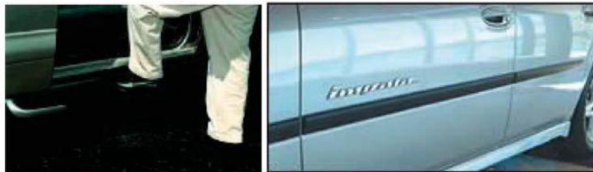
Figure III.6. Deux des premières applications commerciales de nanocomposites dans l'automobile : à gauche, les marches-pieds de mini-vans Chevrolet et GMC et à droite, des baguettes de protection latérale [58].
