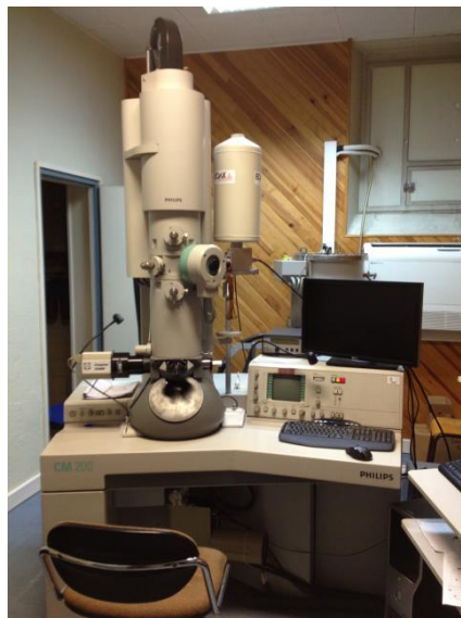
Figure I.13. Microscopie électronique en transmission (MET) PHILIPS CM200
