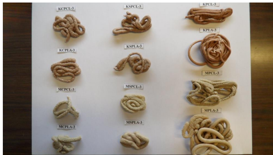
Figure III.33. Image des nanocomposites-2 préparés par voie fondue (extrusion)
