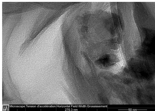
Figure I.31. Micrographie MET de la bentonite.
