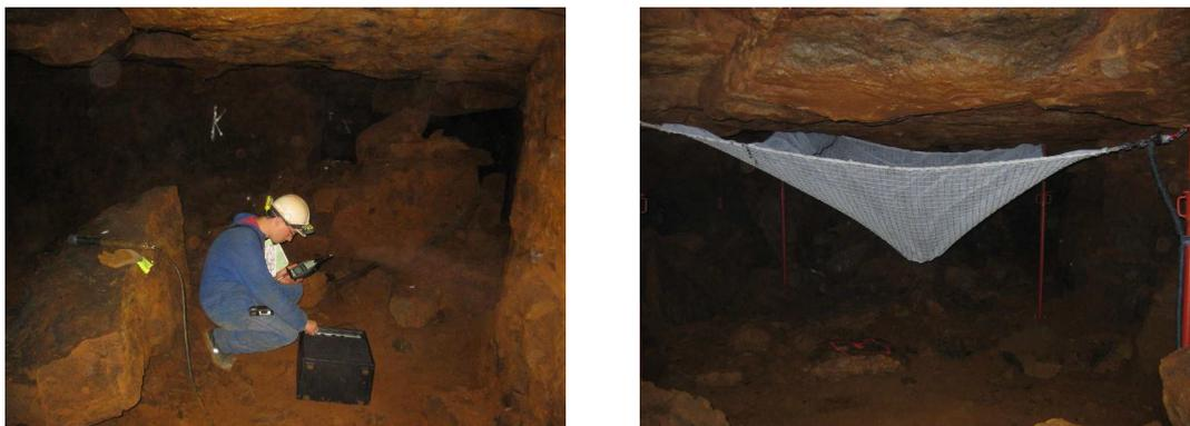
**Figure 22** Solutions mises en place pour la surveillance des chutes de blocs à Moyeuve-Grande (INERIS, 2013)
