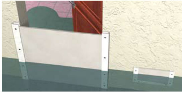
Figure 68 Exemple de dispositifs temporaires d'occultation des portes et bouches d'aération
