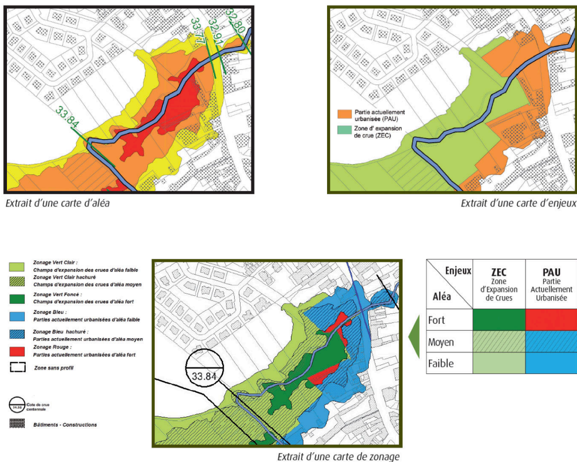
Figure 13 Exemple illustratif de cartes d'aléa, d'enjeux et de zonage du risque lié à une inondation par débordement de cours d'eau
