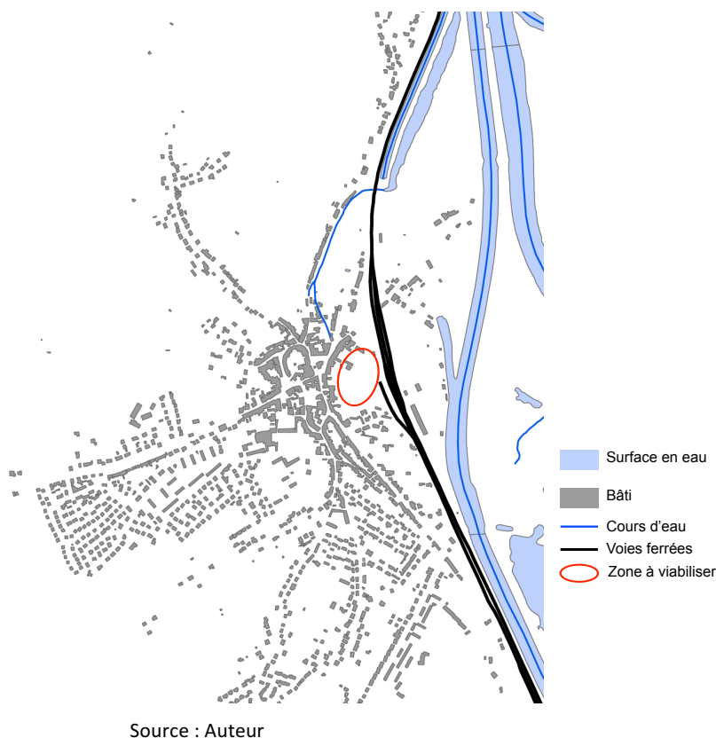
Figure 67 Tracé de la digue (identique à la voie ferrée)
