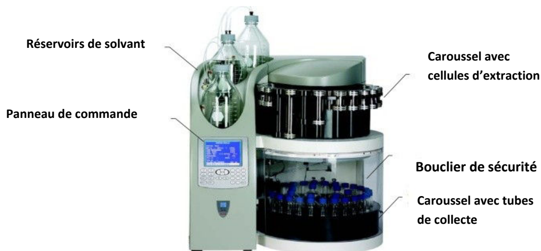
Figure III. 4 : Extracteur ASE 350 (Thermo-Scientific-Dionex).
