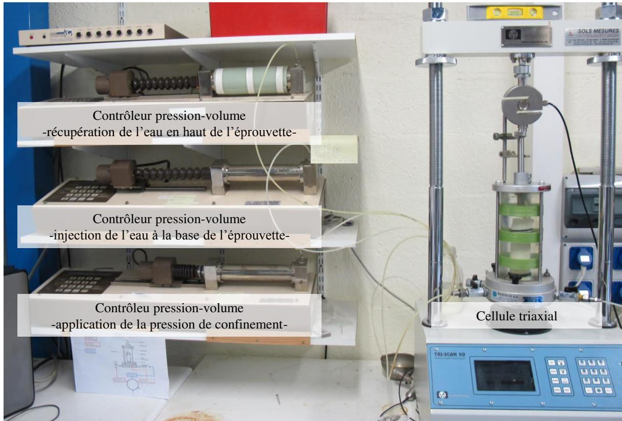
Figure II.17 : Dispositif de mesure de la conductivité hydraulique.
