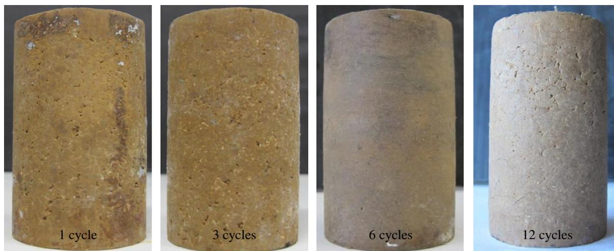
Figure IV.9 : Évolution de l'état des éprouvettes du limon traité avec 3 % de ciment soumises à des cycles hydriques par la méthode-Hr.
