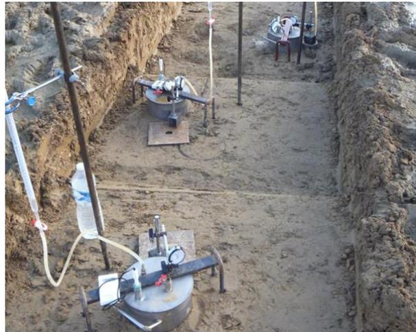
Figure IV.43 : Disposition des perméamètres dans l'excavation.
