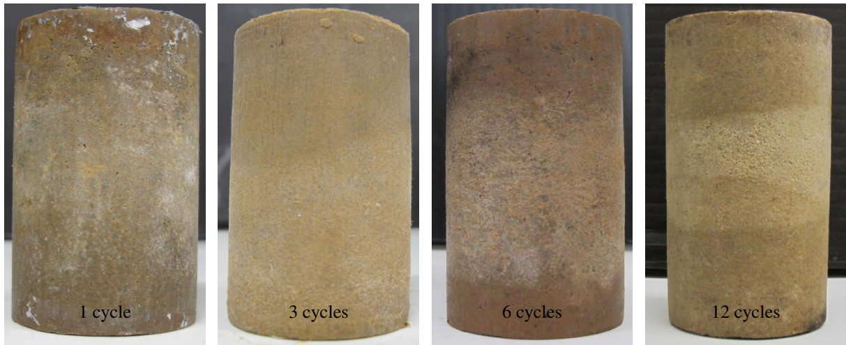
Évolution de l'état des éprouvettes du limon traité avec 6 % de ciment soumises à des cycles hydriques par la méthode-Hr.
