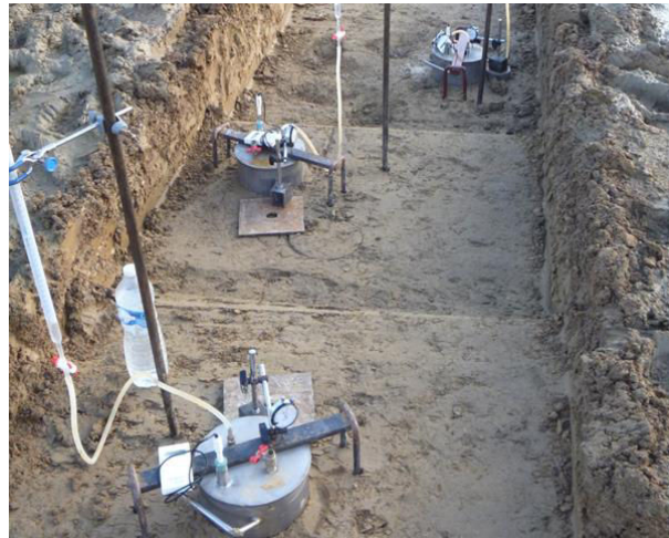
Figure IV.43 : Disposition des perméamètres dans l'excavation.
