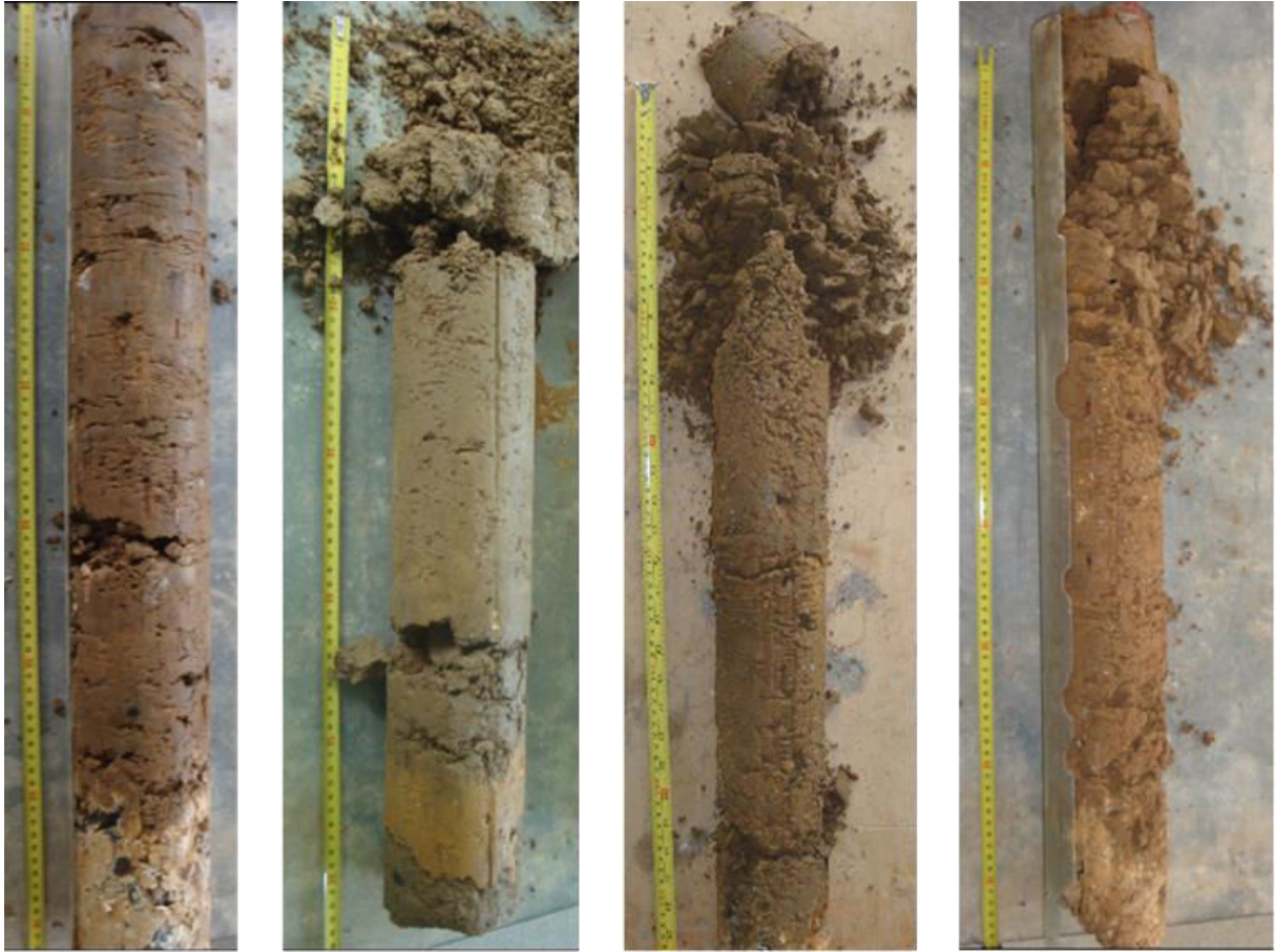
État de quelques sondages carottés réalisés six mois après la mise en service des bassins.
