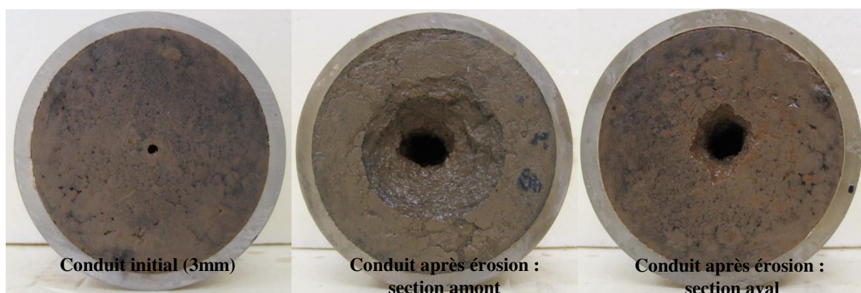
Figure IV.36 : Exemple de l'état d'une éprouvette de limon traité à 6 % de ciment après 6 cycles hydriques par la méthode-Hr (État avant et après essai HET).
