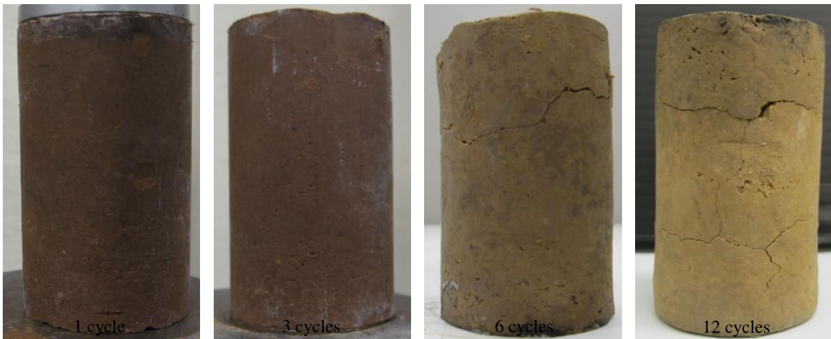
Évolution de l'état des éprouvettes du limon traité avec 5 % de bentonite soumises à des cycles hydriques par la méthode-Hr.
