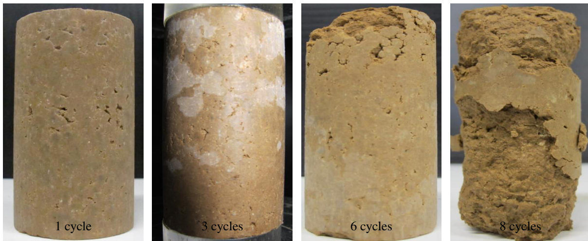
Évolution de l'état des éprouvettes du limon traité avec 3 % de chaux soumises à des cycles hydriques par la méthode-Ag.
