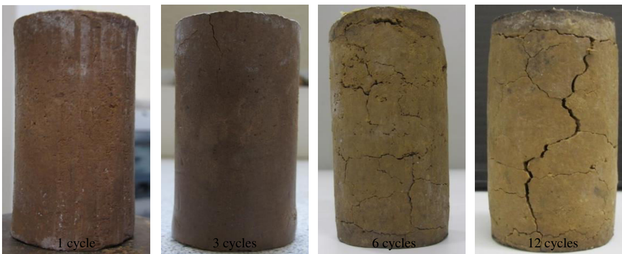
Évolution de l'état des éprouvettes du limon traité avec 9 % de bentonite soumises à des cycles hydriques par la méthode-Hr.
