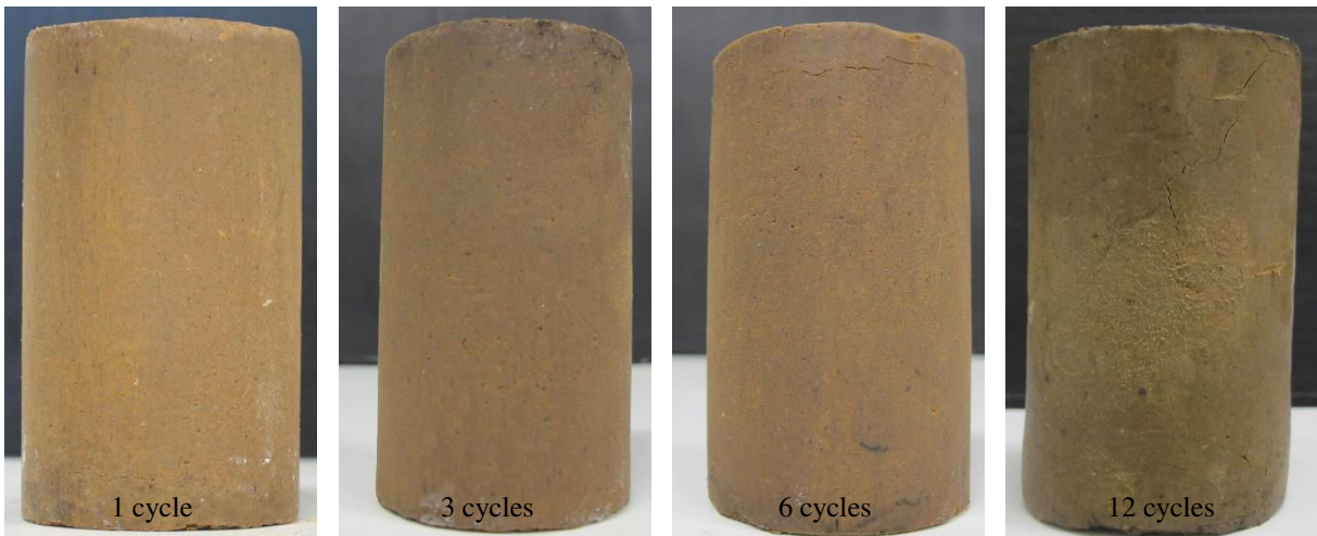
Évolution de l'état des éprouvettes du limon traité avec 5 % de kaolinite soumises à des cycles hydriques par la méthode-Hr.
