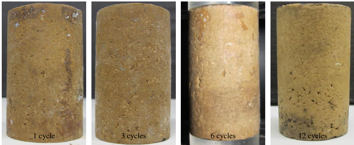
Évolution de l'état des éprouvettes du limon traité avec 3 % de chaux soumises à des cycles hydriques par la méthode-Hr.
