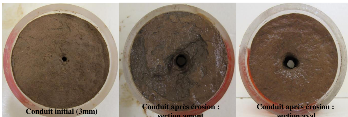
Figure IV.35 : Exemple de l'état d'une éprouvette de limon traité à 3 % de ciment après 12 cycles hydriques par la méthode-Ag (État avant et après essai HET).
