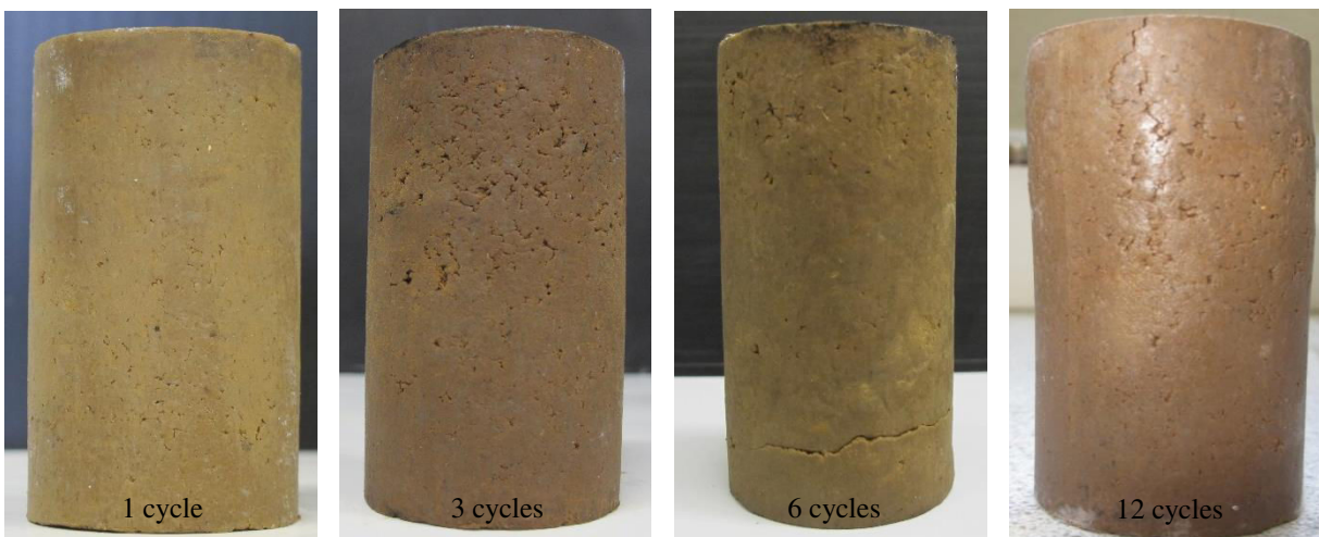
Évolution de l'état des éprouvettes du limon traité avec 9 % de kaolinite soumises à des cycles hydriques par la méthode-Hr.
