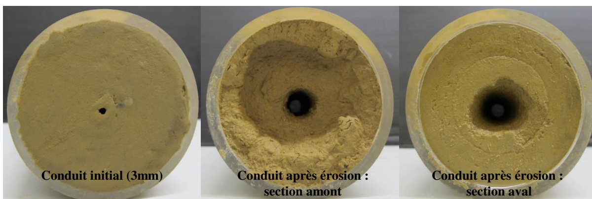
Figure IV.33 : Exemple de l'état d'une éprouvette de limon traité à 3 % de ciment après 10 cycles hydriques par la méthode-Hr (État avant et après essai HET).
