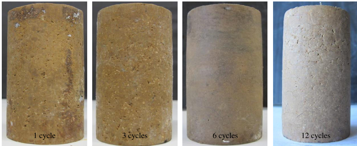
Évolution de l'état des éprouvettes du limon traité avec 3 % de ciment soumises à des cycles hydriques par la méthode-Hr.
