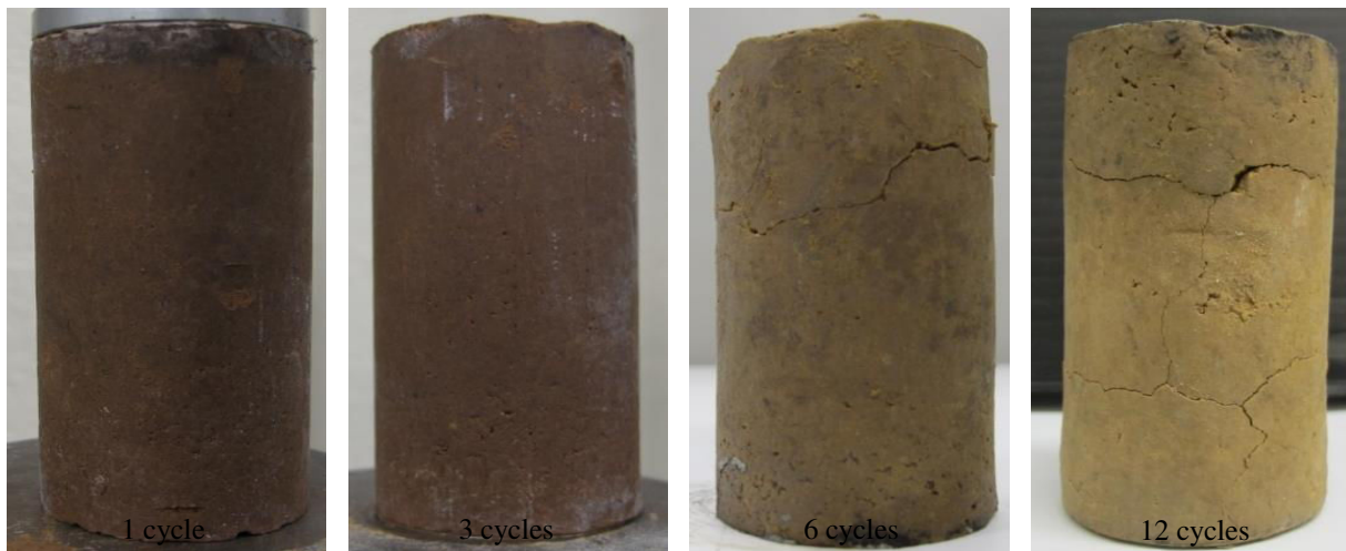
Figure IV.4 : Évolution de l'état des éprouvettes du limon traité avec 5 % de bentonite soumises à des cycles hydriques par la méthode-Hr.
