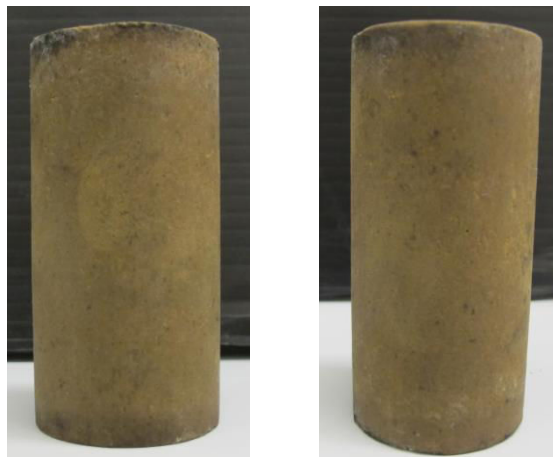
Figure IV.1 : Exemple de deux éprouvettes du limon non traité ayant subi 12 cycles hydriques par la méthode-Hr.
