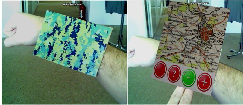
Figure 52 : Illustration du principe de recalage par marqueur : le patch « camouflé » (à g.) et l'IHM de RA affichée dessus (à d.).
