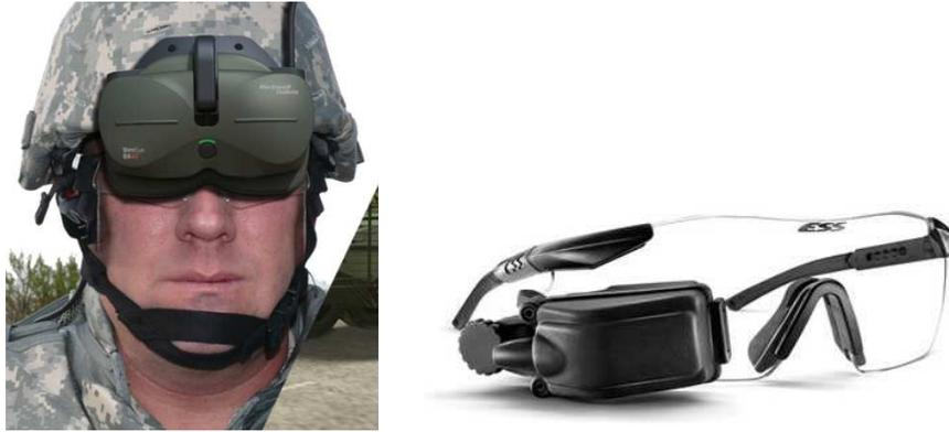
Figure 5 : restituteur immersif binoculaire (à g.) et semi immersif monoculaire (à d.).
