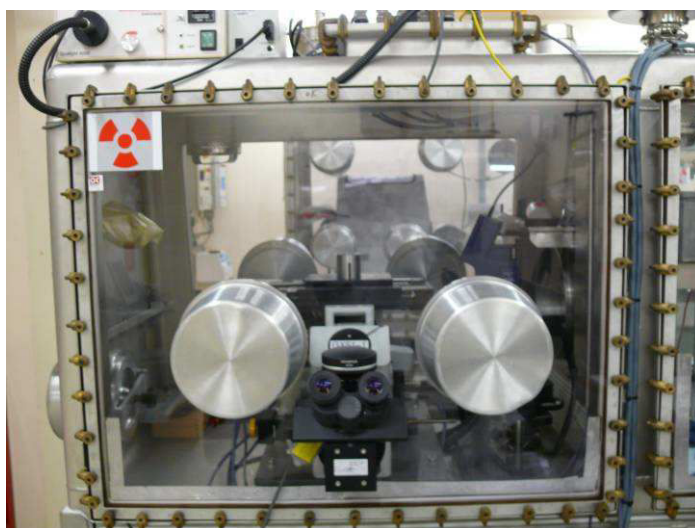
Figure II.17 : Microscope optique (a) placé en boîte à gants sous vide secondaire (b).
