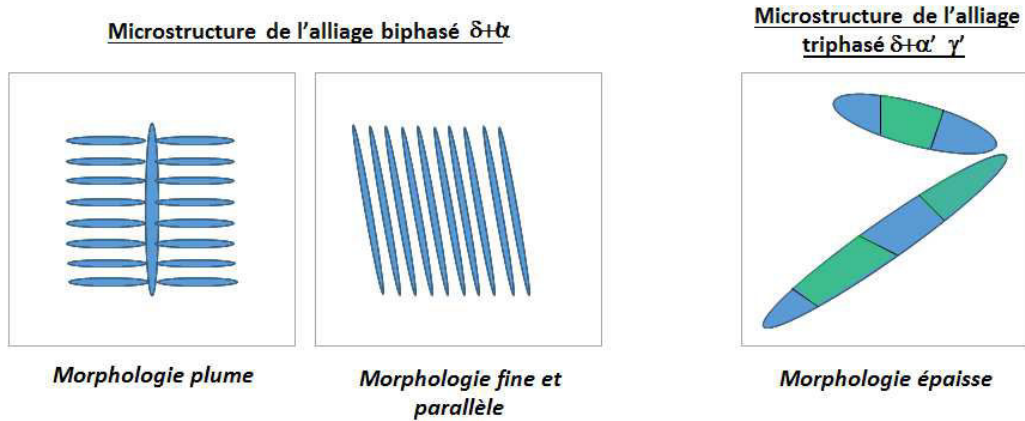
Figure V.37 : Microstructure (a) de l'alliage biphase \delta+\alpha' à la suite d'une transformation à basses températures et (b) de l'alliage triphasé \delta+\alpha'+\gamma' à la suite de l'application d'une sollicitation mécanique.
