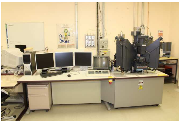
Figure II.20 : Microsonde de Castaing Cameca SX100 utilisée dans le cadre de ces travaux.
