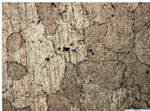
Figure II.27 : Métallographie optique d'un alliage PuGa 1at.% homogène et monophasé δ réalisée à température ambiante. L'analyse de taille de grains réalisée à partir du logiciel Olympus Analysis a révélé une taille de grain moyenne de 60μm.
