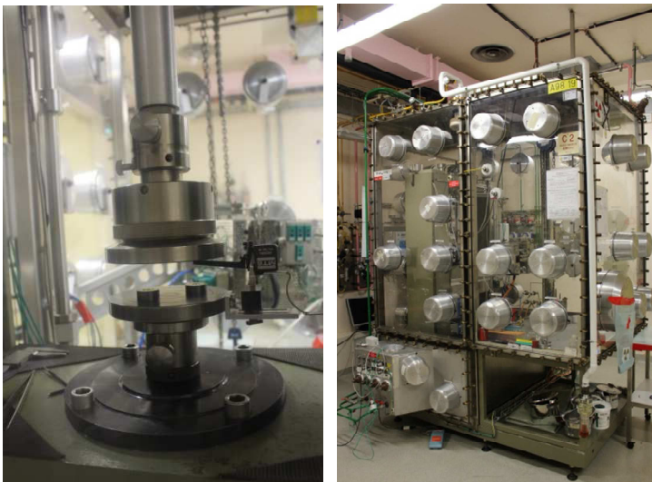
Figure II.23 : Dispositif de compression sous presse Zwick 1474 placé en BàG.
