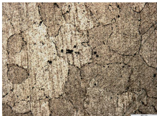
Figure II.27 : Métallographie optique d'un alliage PuGa 1at.% homogène et monophasé \delta réalisée à température ambiante. L'analyse de taille de grains réalisée à partir du logiciel Olympus Analysis a révélé une taille de grain moyenne de 60 \mu\text{m} .
