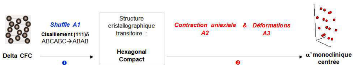
Figure IV.1 : Décomposition d'un chemin de transformation atomique reposant sur une structure intermédiaire hexagonale compacte.
