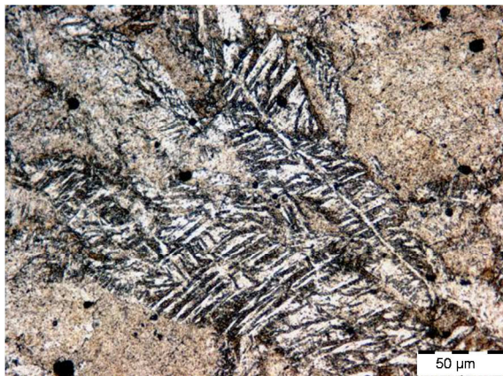
Figure III.13 : Morphologie de la martensite formée dans le premier nez du diagramme TTT (-40°C).
