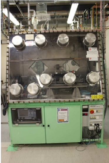
Figure II.22 : Boite à Gants utilisée pour réaliser les mesures ultrasonores.
