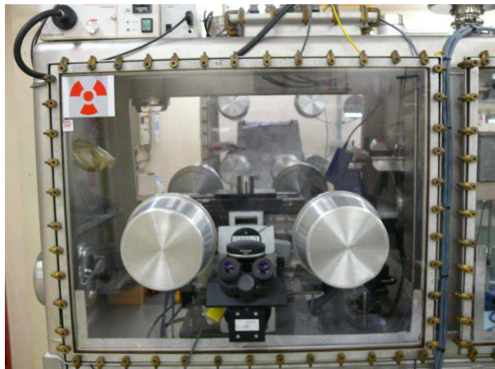
Figure II.17 : Microscope optique (a) placé en boîte à gants sous vide secondaire (b).
