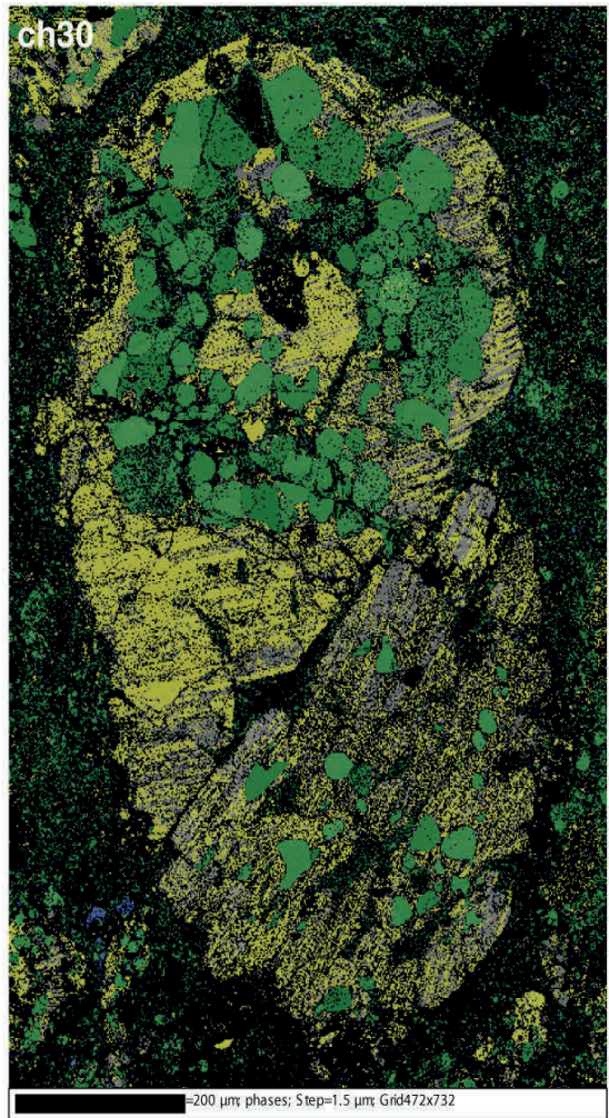
Phases : forstérite : vert ; orthoenstatite : gris ; clinoenstatite : jaune.
