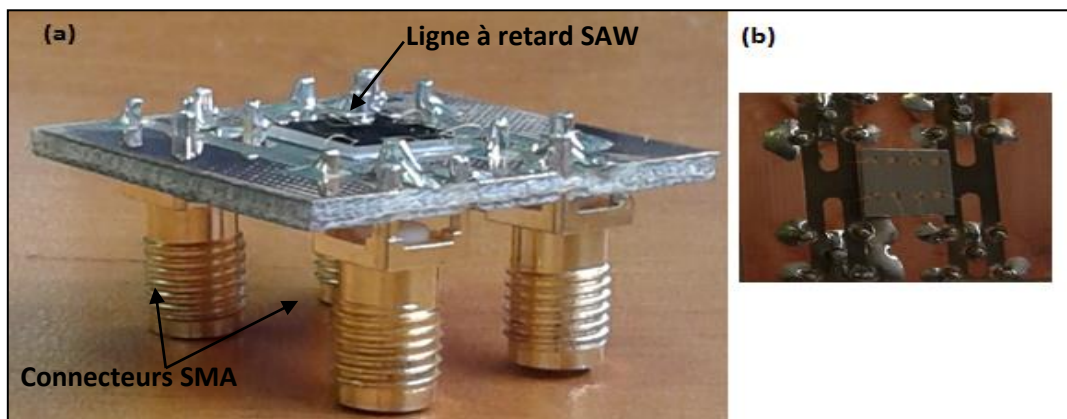
Figure III.34 : Capteur magnéto-élastique à base de la structure multicouche LiNbO 3 /IDT/ZnO/Ni Packagé 101
