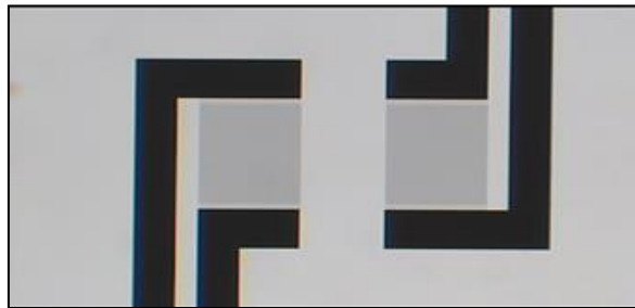
Figure III.23: Illustration d'une ligne à retard en transmission ayant une longueur d'onde de 24µm.
