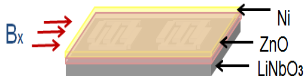
Figure III.38 : Orientation du champ magnétique par rapport à la structure magnéto élastique Ni/ZnO/IDT/LiNbO 3
