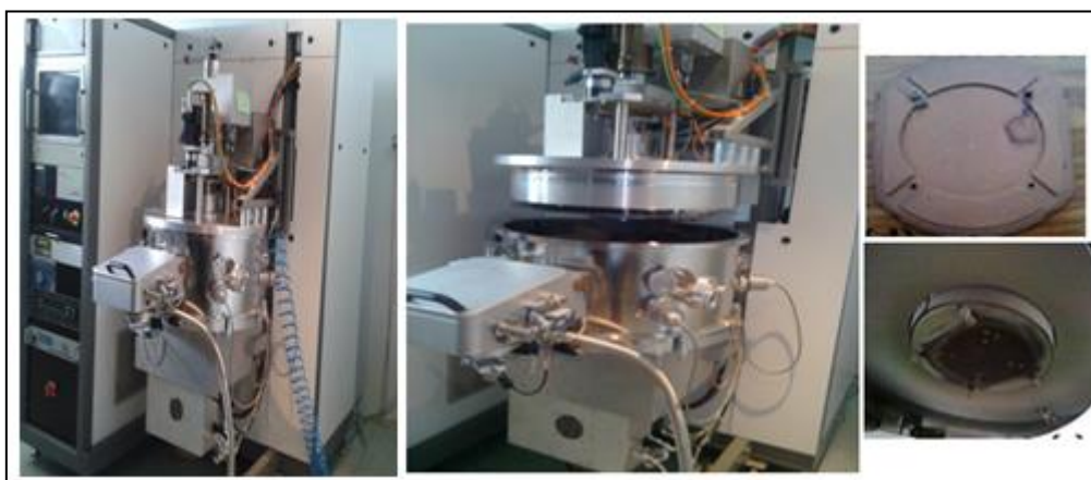
Figure III.25 : Bâti de pulvérisation de l'équipe 405 utilisé pour le dépôt de ZnO
