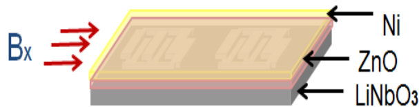
Figure III.38 : Orientation du champ magnétique par rapport à la structure magnéto élastique Ni/ZnO/IDT/LiNbO 3
