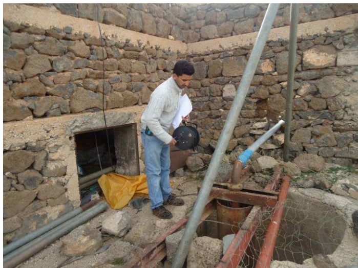
Photo 10.6 : Illustration d'une mesure manuelle du niveau de la nappe.
