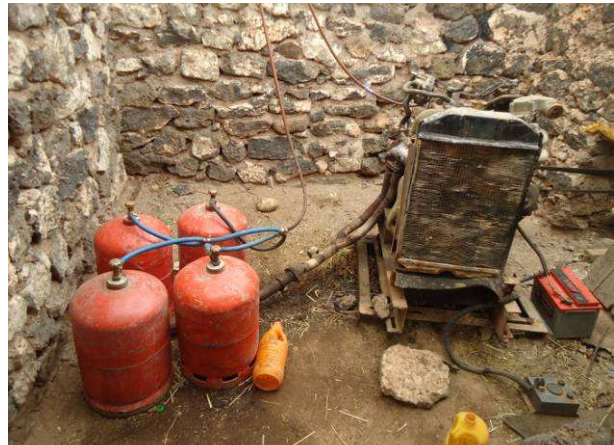
Planche photos 9.3 : Exemple de motopompes utilisé de le Haut Sebou.
