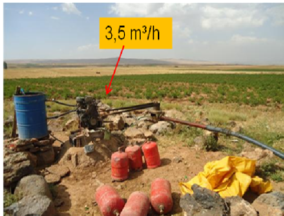
Planche photos 9.3 : Exemple de motopompes utilisé de le Haut Sebou.
