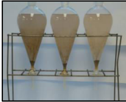
Figure 51 Décantation en triplicat du ZnS des solutions L1 Zn de la couche C2
