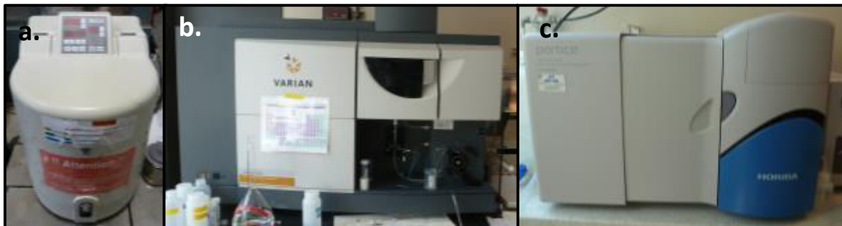
Figure 18 Photographie des équipements utilisés pour les analyses, a. Broyeur à billes, b. Plasma à couplage induit avec spectromètre d'émission atomique (ICP-AES), c. Granulomètre laser.
