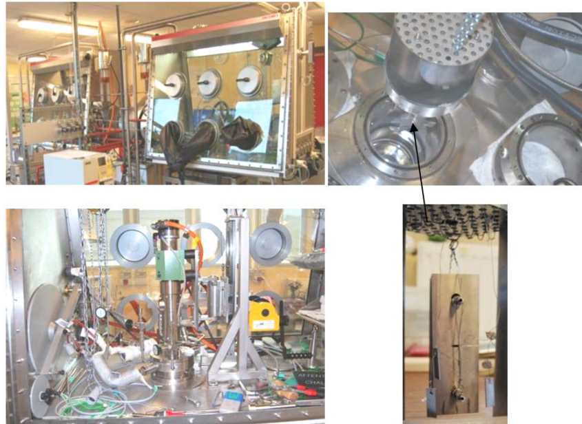
Figure I-3 : Dispositif d'essai CORRONa utilisé pour tester les échantillons en alliage de vanadium V-4Cr-4Ti avec et sans revêtement dans le milieu sodium liquide
