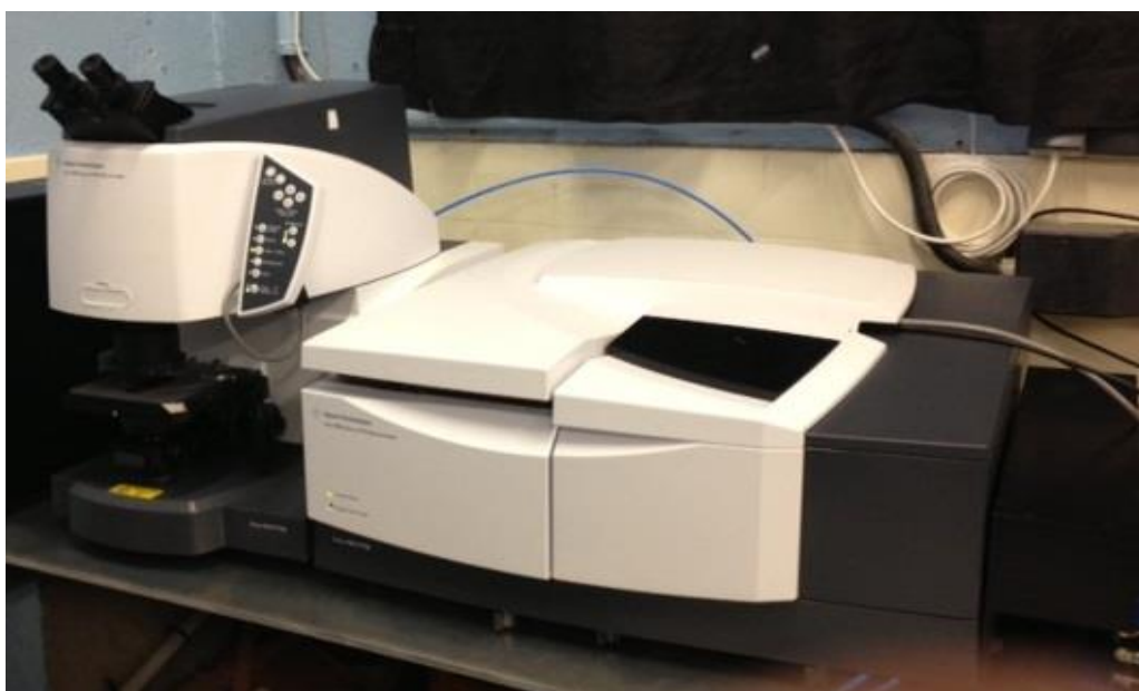
Figure 25 : Spectromètre et microscope FTIR Agilent Cary série 680.
