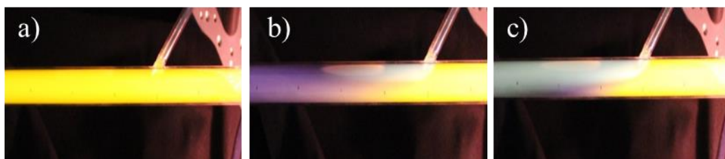
Figure 38: Images de la zone de mélange entre le gaz titrant (Ar-1.4%NO) et la post-décharge ( Q_{N_2}=100 Nccm, Q_{Ar}=1050 Nccm, P= 20 mbar, P_w = 100 W). a) avant introduction du mélange (Ar-NO), b) à faible débit du mélange (Ar-NO), c) et à fort débit du mélange (Ar-NO).
