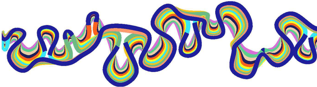
FIGURE 3.6 – RÉSULTAT DE LA CROISSANCE D’UN CHENAL INCLUANT LA FORMATION DE BRAS-MORT.
